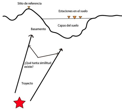
**Figura 1.1:** Diferencia entre el movimiento del basamento y el movimiento de referencia.
