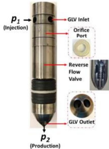
Figura 4.4 Válvula de bombeo neumático de orificio (Coutinho, 2018).
