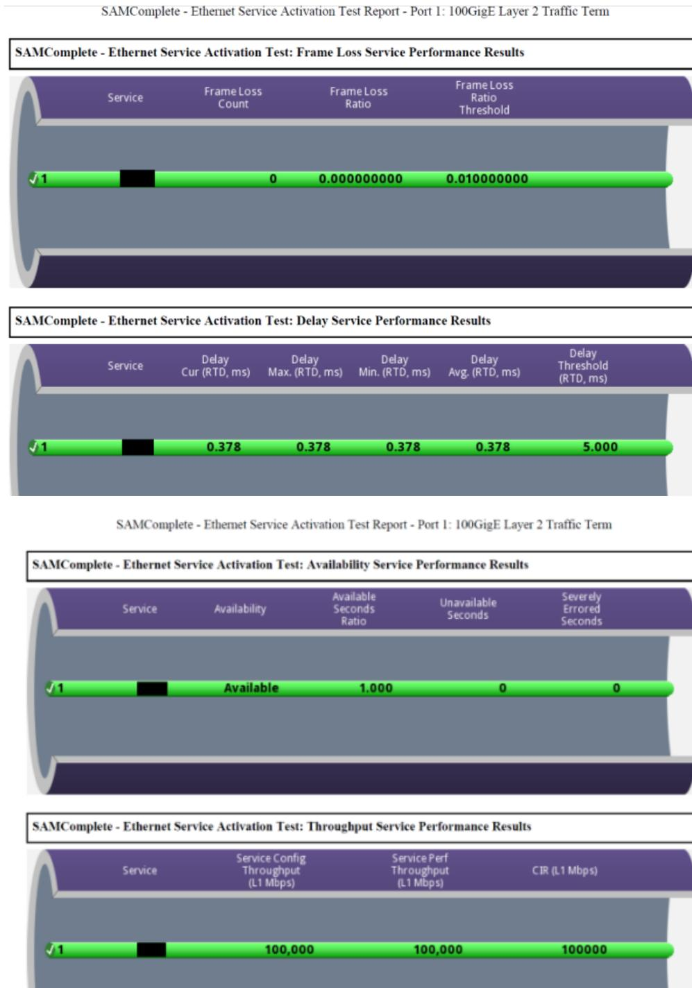
Figura 3.5: Resultados del Throughput, frame loss, delay y jitter de la prueba de medio.
