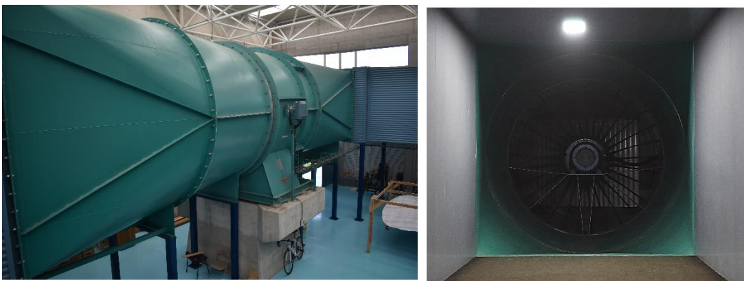
Figura 3.8 Ventilador visto desde el exterior (izquierda) y al interior del túnel (derecha).
