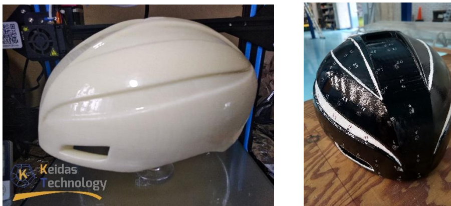
Figura 5.2 Manufactura del modelo propuesto (izquierda) y modelo terminado (derecha)
