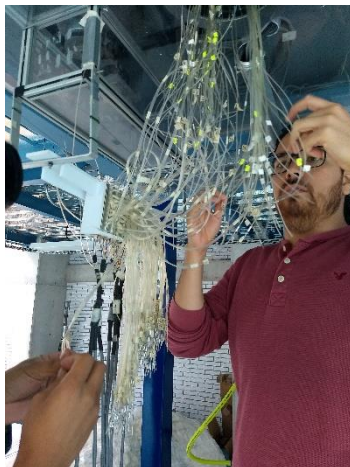
Figura 5.12 Conexión de mangueras de modelo a ZOCs.
