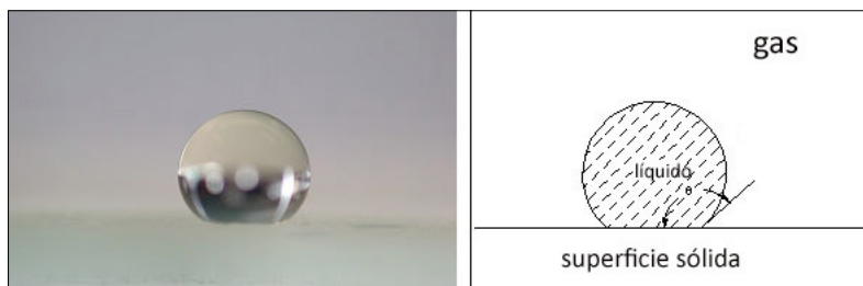
FIGURA 1. Aspecto de una gota de agua sobre una superficie hidrofóbica [5]
