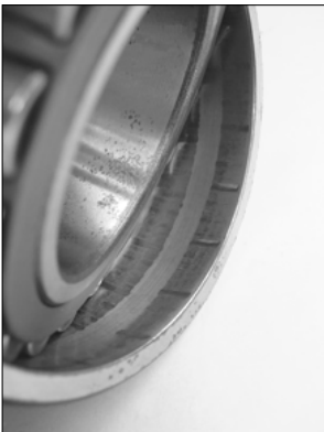
FIGURA 22. Imagen de pista externa de rodamiento, con numerosas marcas de fretting por impacto.
