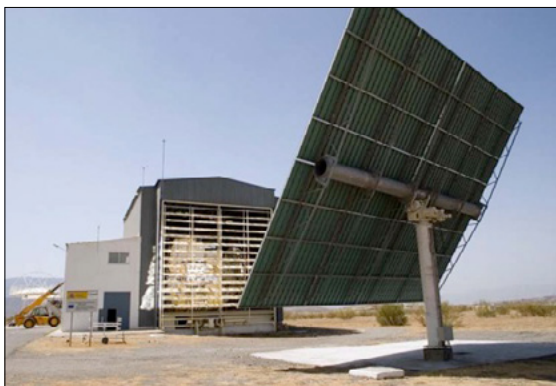
FIGURA 16. Horno solar en la Plataforma Solar de Almería, España
