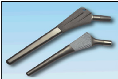
FIGURA 16. Prótesis rociada térmicamente por la técnica VPS. La hidroxiapatita es un material cerámico bioactivo que acelera el crecimiento del hueso sobre la superficie del implante creando una unión firme
