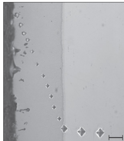
FIGURA 11. Perfil de microdurezas Vickers para un acero inoxidable 304 austenítico aluminizado a 1023°K durante 4 horas
