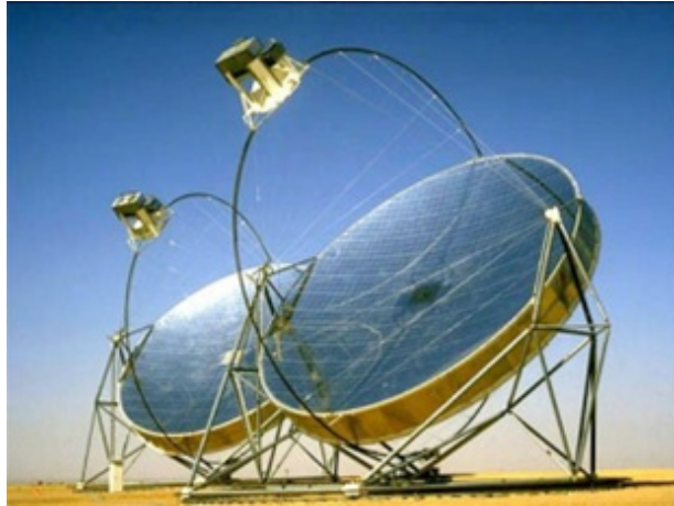
FIGURA 9. Concentrador solar de disco parabólico de membrana tensionada de 17 m de diámetro
