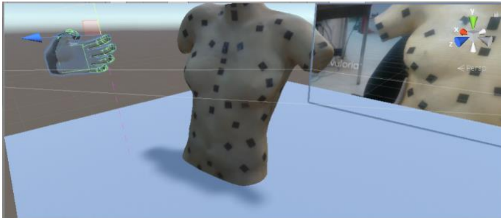
Figura 38- Prueba de la escena en Unity 3d al reconocer marcador de tipo CylinderTarget en el cuello y haciendo uso del sensor Leap Motion para manos.
