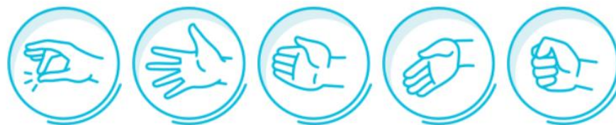
Figura 31- Gestos de Myo, de izquierda a derecha: Double Tap , Fingers Spread , Wave Right , Wave Left y Fist ( Myo Gesture Control Armband Tech Specs , s. f.).
