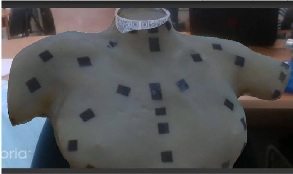
Figura 20- Prueba de alineación con marcador cilíndrico en el cuello y con el maniquí colocado en vertical. En esta imagen se observa el modelo del maniquí escaneado previamente.
