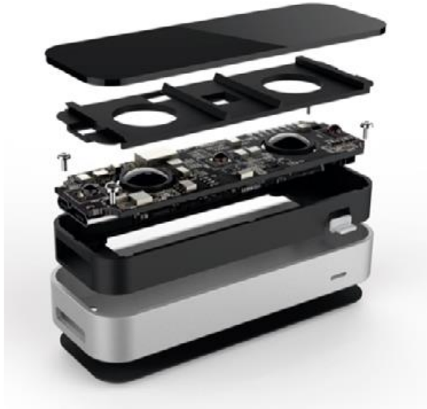
Figura 25- Estructura Leap Motion (Tracking | Leap Motion Controller | Ultraleap, s. f. Recuperado 16 de noviembre de 2020, de https://www.ultraleap.com/product/leap-motion-controller/ ).
