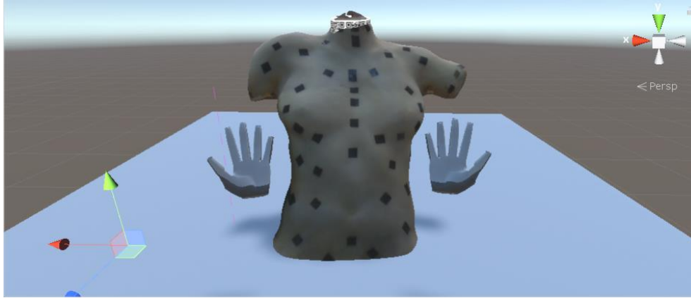
Figura 33- Escena en Unity 3d con modelo del maniquí, las manos añadidas del sensor LeapMotion y el target cilíndrico.
