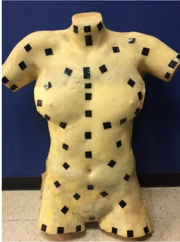
Figura 13- Marcador fiduciario, primer marcador con el que se probó Vuforia en Unity 3d.
