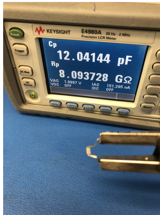
Figura 3.4: Medición de un MLCC de 12 pF ayudado de un medidor de impedancias.
