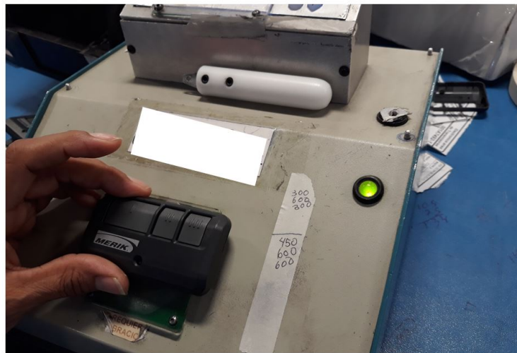
Figura 3.11: Fotografía de un transmisor antes de ser probado en un equipo local.
