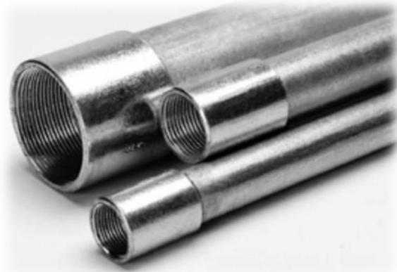
Utilizadas en instalaciones ocultas o visibles, en cualquier tipo de ambiente y bajo cualquier condición climática, encontrados en el mercado en forma galvanizada o con una capa de color negro esmaltado fabricado en diámetros de 13[mm] (1/2") hasta 152.4 [mm] (6") y se comercializa en acero o aluminio.
