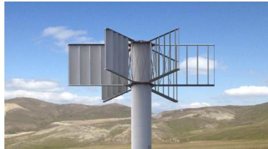
Figura17. Aerogenerador Vertical
