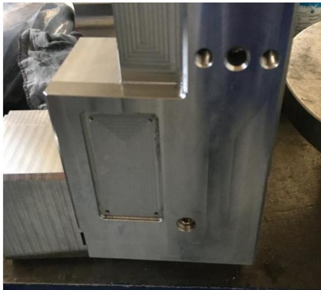
*Fig. 10 Molde al cual se le tuvo que diseñar y hacer el espacio para la placa de identificación*
