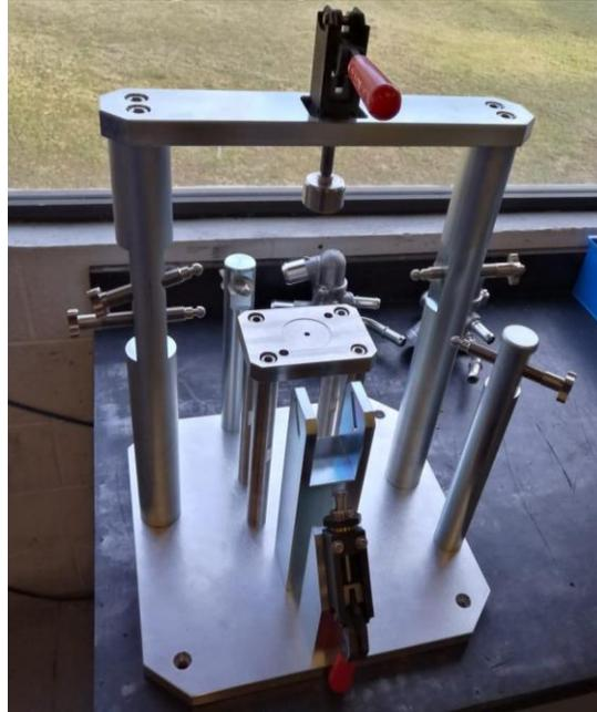
*Fig. 41 Dispositivo de hermeticidad en etapa de ensamble*
