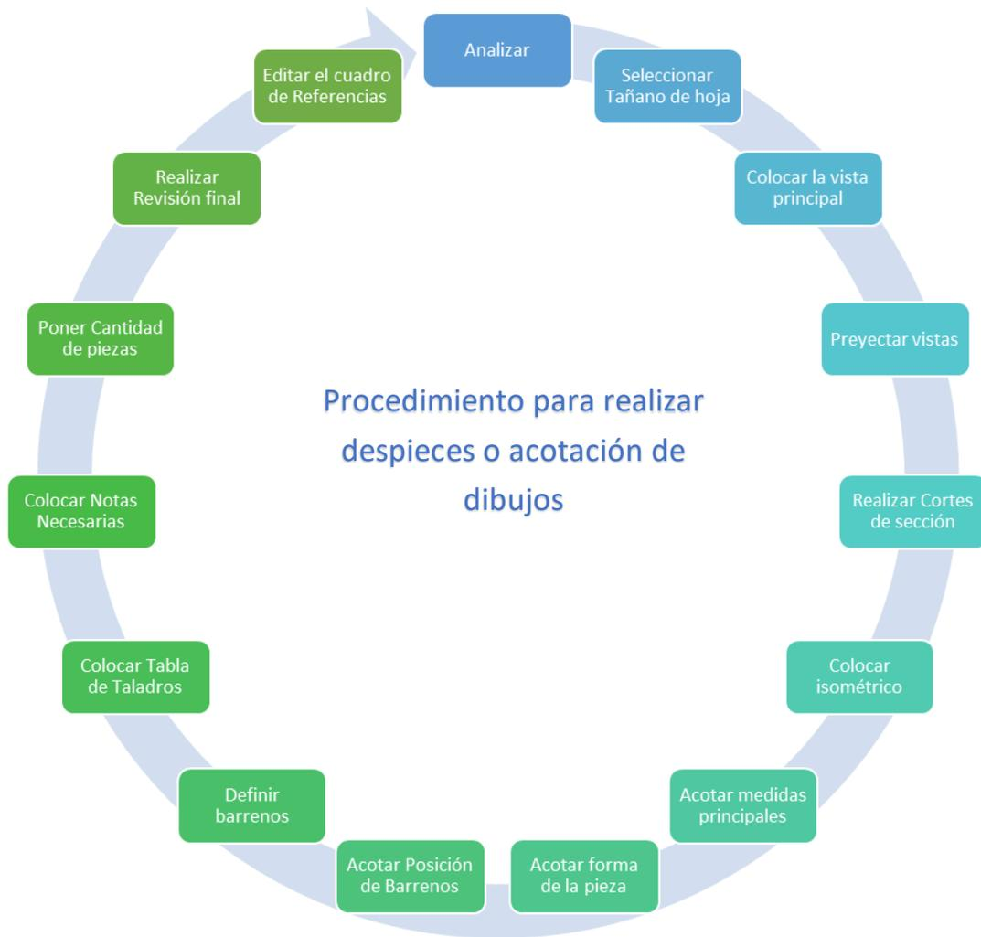
*Fig. 12 Procedimiento para realizar acotación de dibujos.*
