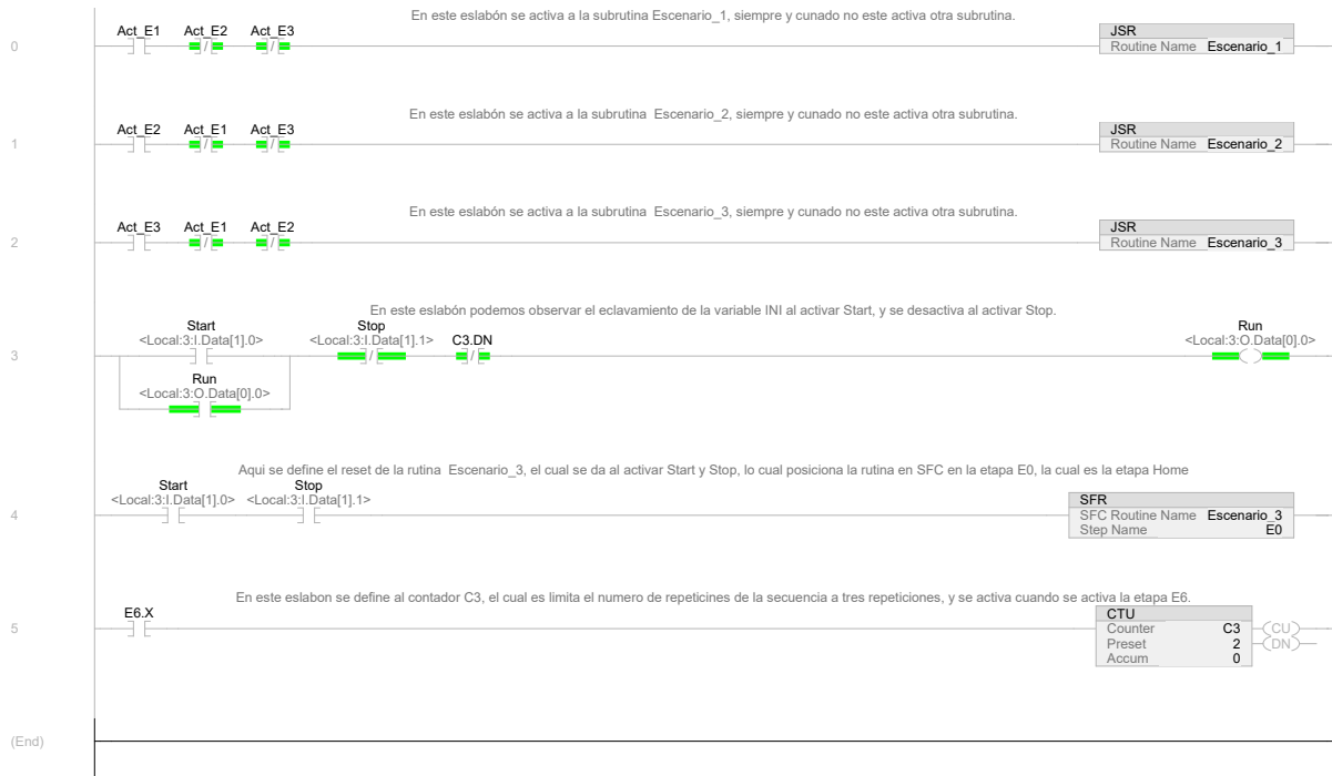
Figura B.1 Rutina en lenguaje LD implementada en Studio 5000 Logix Designer.
