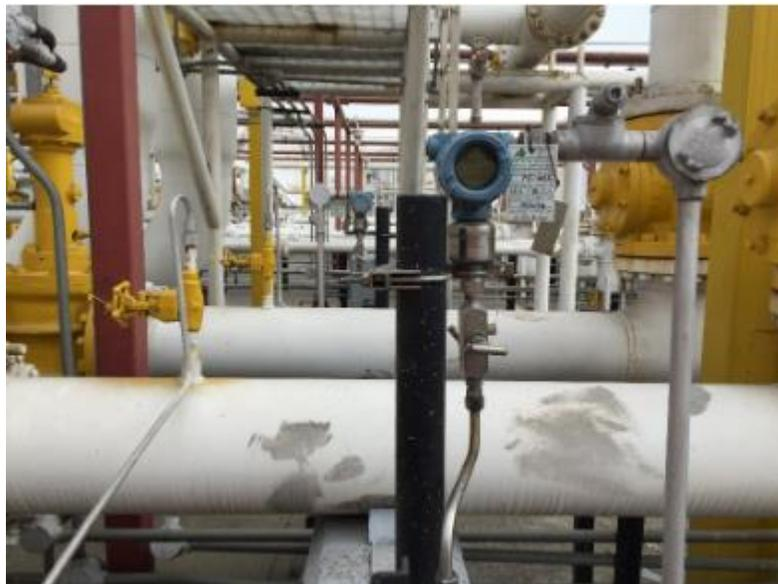
Figura 2. Indicador de Presión. Fuente: Fotografía tomada en campo de trabajo, 2020.
