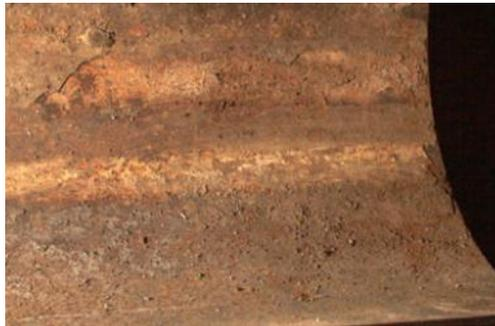
**Figura 1.5** Corrosión uniforme (NACE, 2003).
