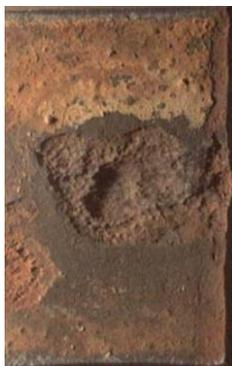
**Figura 1.7** Corrosión por picadura (NACE, 2003).
