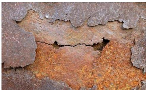
**Figura. 1.8** Corrosión en grietas o hendiduras (Training Argentina Oil & Gas, 2019).
