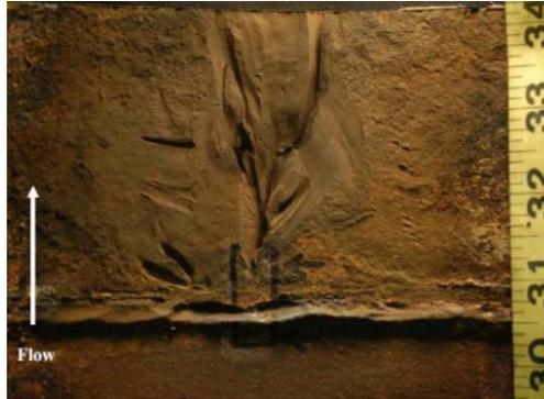
**Figura 1.11** Corrosión-erosión (Manual NACE, 2003).
