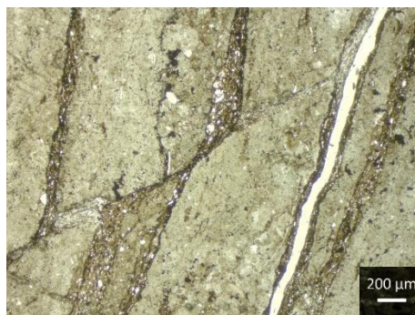
Fig. 5.23 Fotomicrografía de una caliza manganesífera de muy baja ley. Nótese la falla normal y la porosidad que es paralela a la laminación.
