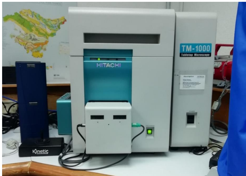
Fig. 3.3 SEM portátil TM-1000 del Laboratorio de Petrografía y Microtermometría del Departamento de Recursos Naturales del Instituto de Geofísica, UNAM.
