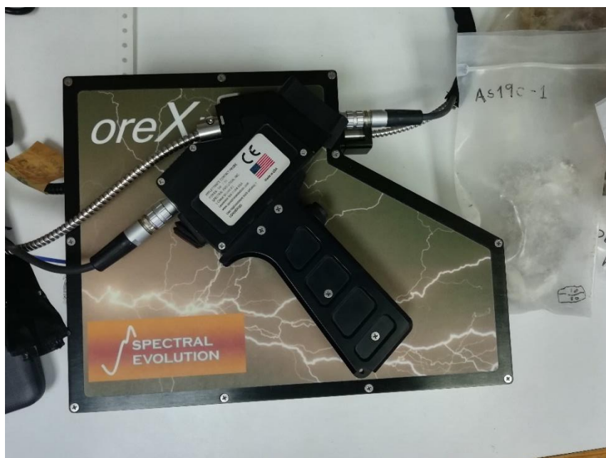
Fig. 3.2 Espectrómetro portátil SWIR para análisis mineral Orexpress de Spectral Evolution ubicado en el Laboratorio de Petrografía y Microtermometría del Departamento de Recursos Naturales del Instituto de Geofísica, UNAM.
