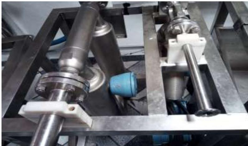
**Figura 7.** Medidor de flujo de Efecto Coriolis con soporte. Fuente: Tomada en laboratorio de trabajo, 2020.
