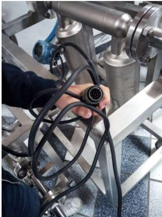
**Figura 18.** Conexión del transmisor. Fuente: Tomada en campo, 2021.
