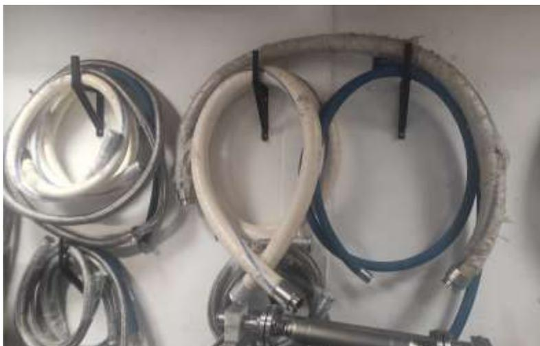
**Figura 9.** Mangueras de Neopreno empleadas en laboratorio para soportar presión y condiciones de flujo. Fuente: Tomada en laboratorio de trabajo, 2020.
