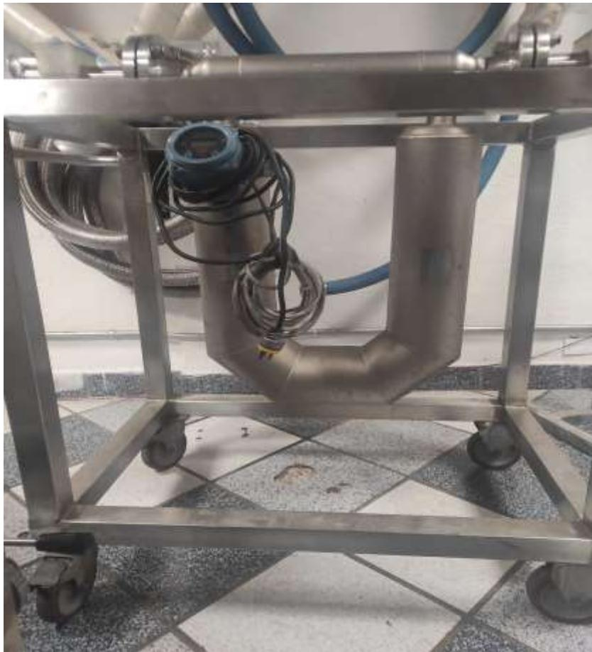
**Figura 23.** Medidor Coriolis desarmado Fuente: Tomada en laboratorio de trabajo, 2021.
