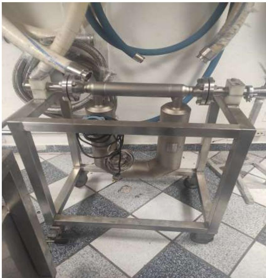
**Figura 8.** Medidor de flujo de efecto Coriolis montado y ajustado con el torque especificado por el fabricante. Fuente: Tomada en laboratorio de trabajo, 2020.
