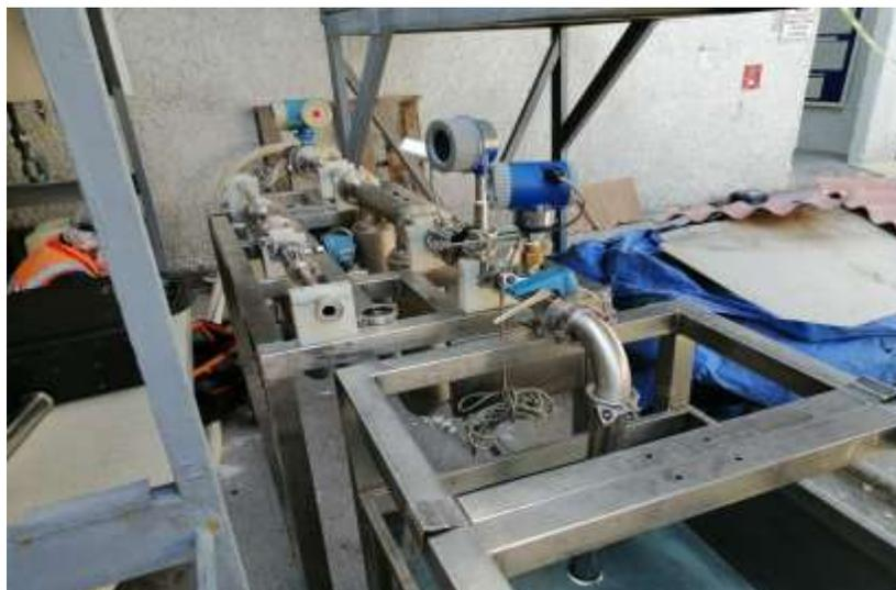
**Figura 15.** Medidor de flujo de efecto Coriolis instalado. Fuente: Tomada en campo, 2021.
