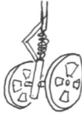
Figura 4.16: Tren de aterrizaje delantero: amortiguador con doble rueda.
