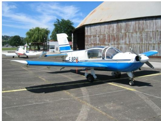
Figura 4.6: Tren de aterrizaje configuración de triciclo . (MITMA, 2007).
