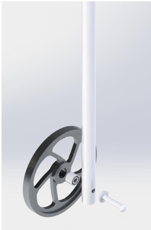
Figura 4.43: Configuración tren de aterrizaje delantero.
