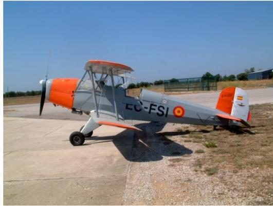
Figura 4.5: Tren de aterrizaje configuración de cola . (MITMA, 2007).
