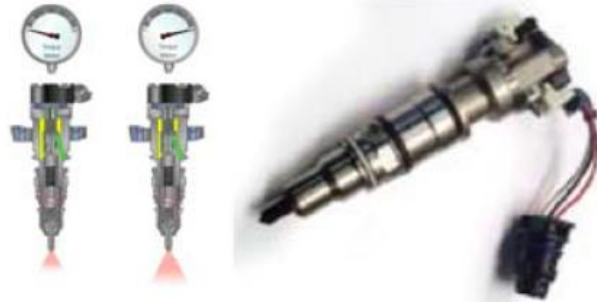
Figura 1-12 Boquillas para inyectores de combustible en motores Diesel
