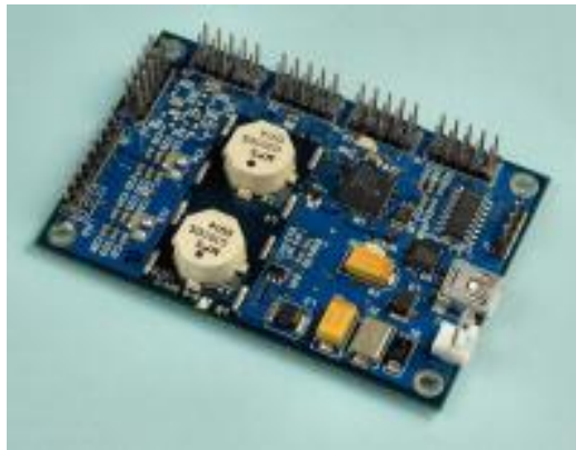
Figura 4-2 Controlador para el motor MC-1100[21]
