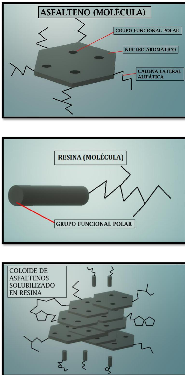
**Figura 18.** Solubilización de asfaltenos por moléculas de resina.
