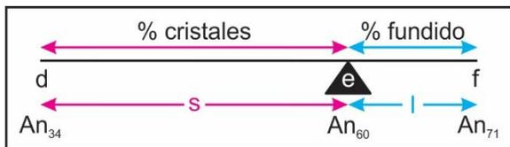
**Figura 5.** La regla de la palanca permite determinar el porcentaje de las fases d y f de un sistema de composición global e, que coexisten en equilibrio a 1400 °C.
