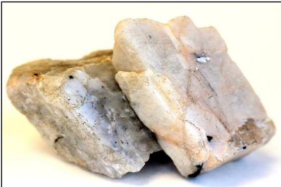
**Figura 2.** La plagioclasa es una solución sólida entre los minerales puros albita y anortita. Una plagioclasa de composición  $\text{An}_{30}$  está compuesta por el 30% del componente anortita y por el 70% del componente albita. Imagen tomada de <https://www.flickr.com/photos/udgeology/2315101335>.
