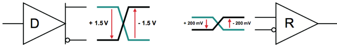
Figura 2: Niveles de voltaje de RS-485
