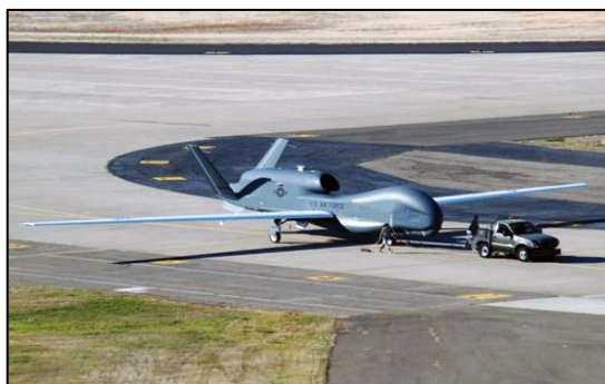
Figura 1- 10 RQ-4A Global Hawk aeronave no tripulada con autonomía de vuelo y un alcance de 16 000 km.
