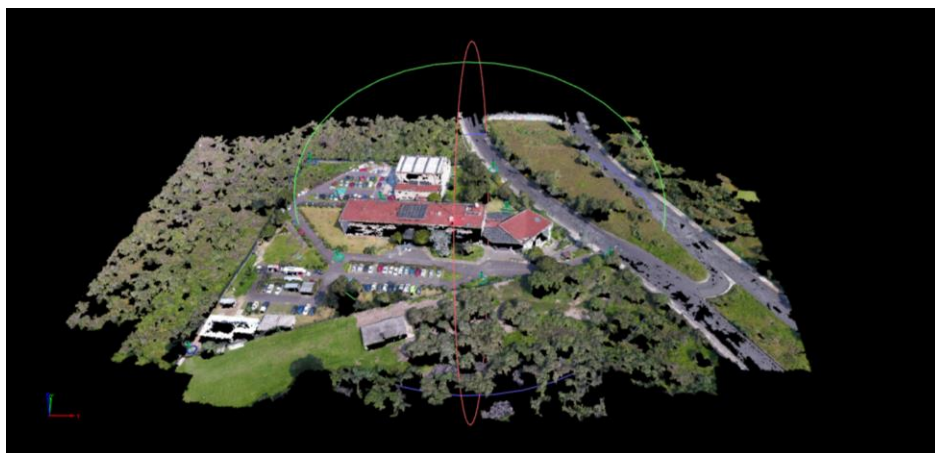
Figura 3- 1 Nube de puntos del CENAPRED. Reconstrucción de estructuras. Para mejorar la calidad y definición es marca con polígonos los edificios y vegetación, es decir, segmentar la nube de puntos.
