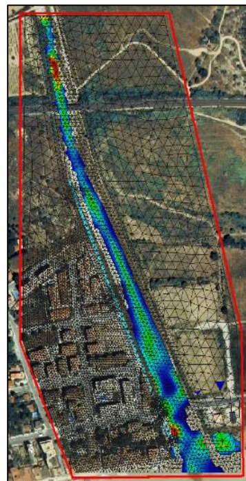
Figura 3- 19 Escenario de inundación con obras de mitigación. En este caso se determinó simular un dique en la zona de falla del río para contener el agua de la avenida del río. Se puede apreciar que el área afectada se redujo considerablemente.
