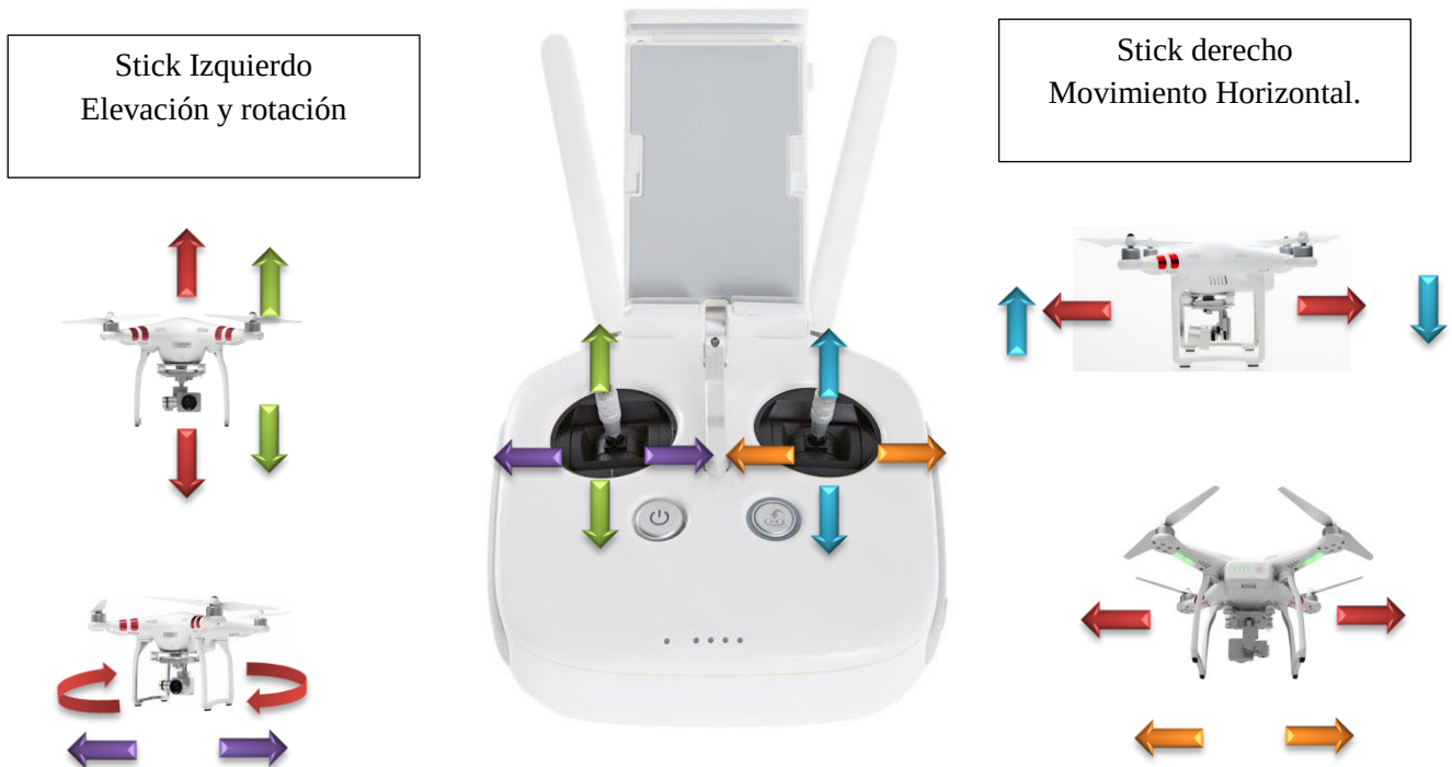
Figura 1- 24 Controladores para movimiento horizontal y vertical.
