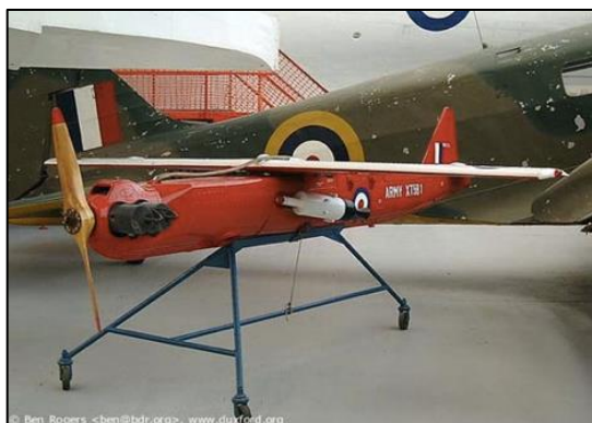
Figura 1- 4 RP-71 Falconer, Primer Aeronave no tripulada para realizar reconocimiento del terreno, este modelo deja de ser una aeronave de un solo vuelo.
