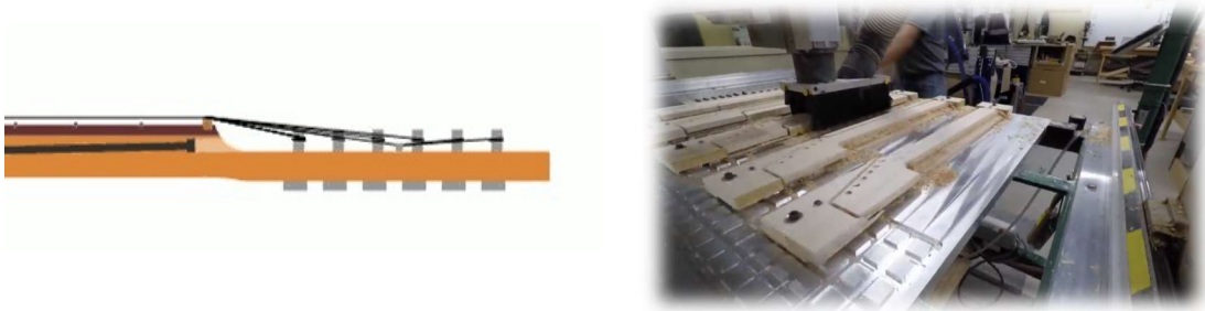
Figura 22 Esquema de un mástil con clavijero recto (izquierda) y su manufactura a partir de una sola pieza de madera (derecha).
