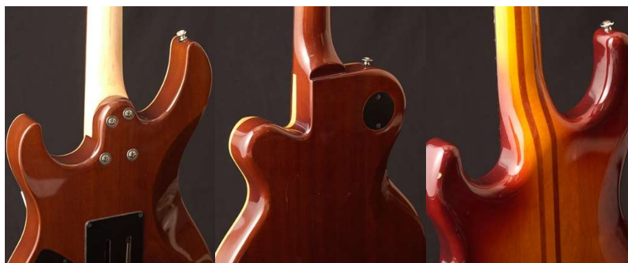
Figura 32 Guitarras con distintos métodos de unión mástil-cuerpo: bolt on (izquierda), set neck (centro) y neck-through (derecha)
