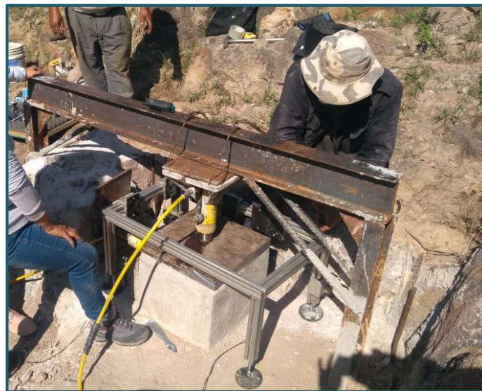
Figura 5.27. Bloque de ensayo sobre una discontinuidad horizontal para la prueba de corte directo
