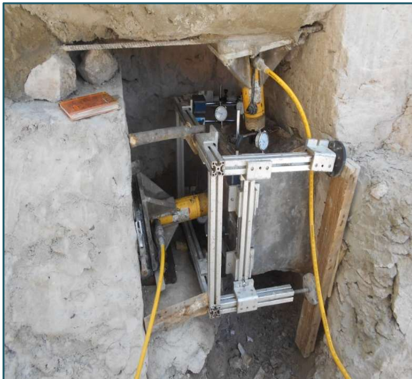
Figura 5.21. Bloque de ensayo para la prueba de corte directo 1 sobre un plano de discontinuidad vertical en Riolita Vesicular Superior.
