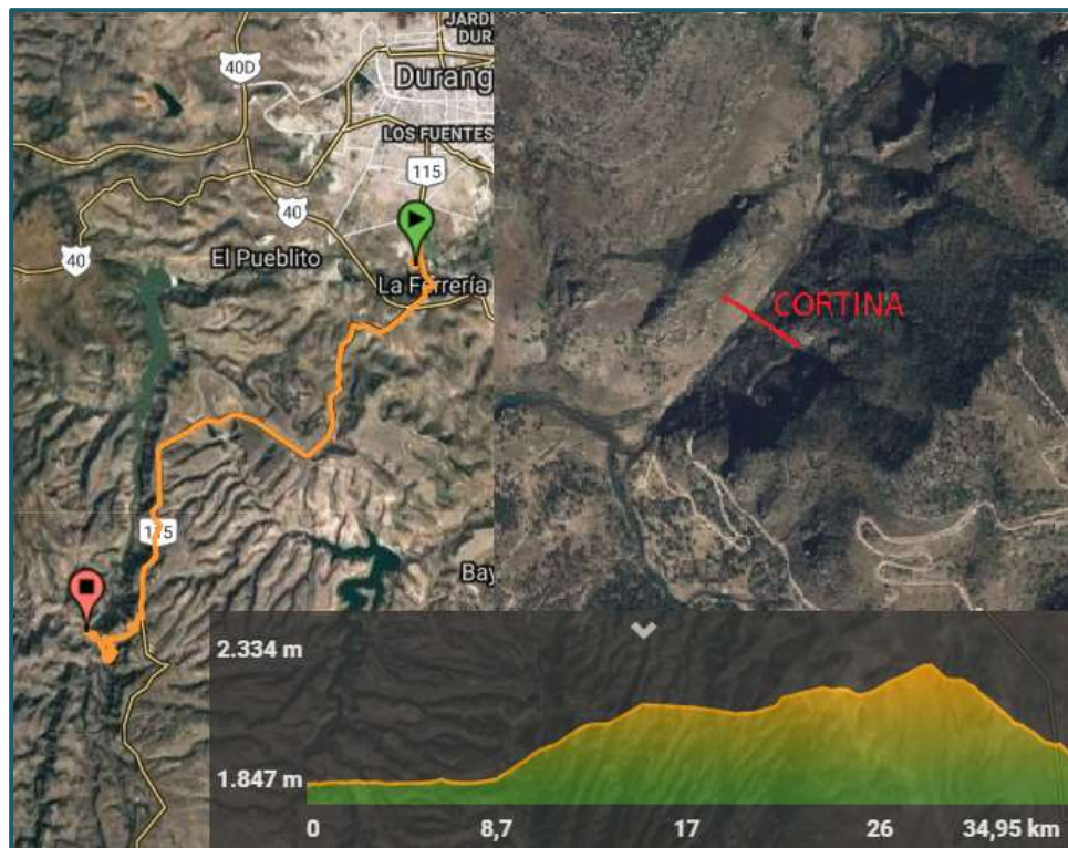
Figura 2.1. Perfil topográfico y ubicación de la zona de estudio propuesta para la construcción de la presa de almacenamiento "El Tunal II" y la ruta de acceso al poblado La Ferrería, cercana a la zona de estudio.
