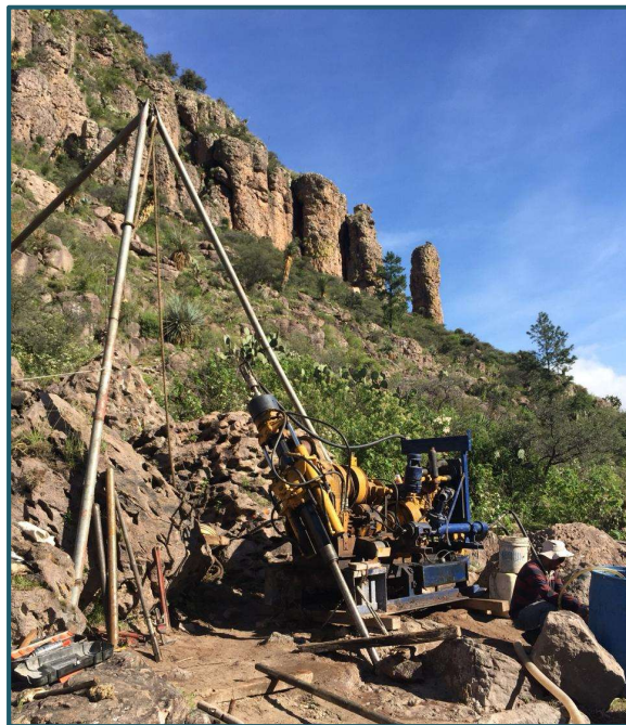
Figura 5.18. Barreno SR-18 inclinado a un costado del cauce del río aproximadamente a 70 m del eje de la cortina.
