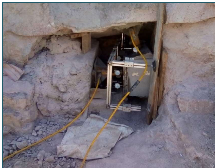
Figura 5.25. Bloque de ensayo sobre plano vertical en Riolita Vesicular Superior en el que se efectuó la prueba de corte directo 3.
