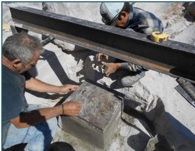
Figura 5.23. Bloque de ensayo para la prueba de corte directo 2 en Riolita Vesicular Inferior sobre un plano horizontal.
