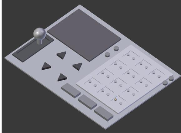
*Figura D.7 Segunda iteración del modelo tridimensional del módulo de protoboard y generador de señales. Se modificó la proporción del modelo y se redistribuyeron los componentes.*
