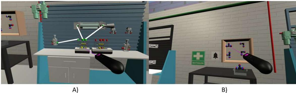
**Figura 4.9 Conexiones restantes válvula 5/2 monoestable y selección de uniones. A) Conexión de la salida B al racor B y conexión pilotaje X a salida válvula 3/2 monoestable, B) Selección de unión T**
