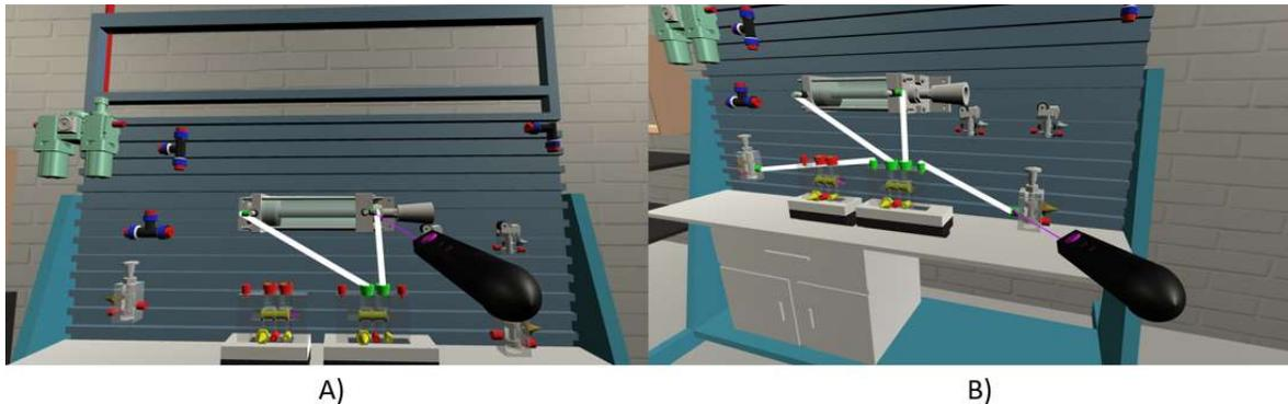
Figura 4.19 Conexiones de una válvula 5/2 biestable. A) conexiones entre salidas A y B a racores A y B, B) conexión pilotaje X & Y a salida de la primera válvula 3/2 monoestable y a salida de la segunda válvula 3/2 monoestable, respectivamente
