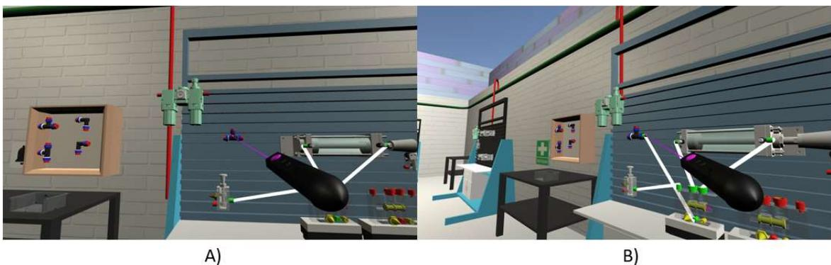
**Figura 4.10 Conexión a unión T. A) Reposicionando la unión T dentro de la mesa, B) Conexión entre unión T y alimentación de la válvula 5/2 monoestable**
