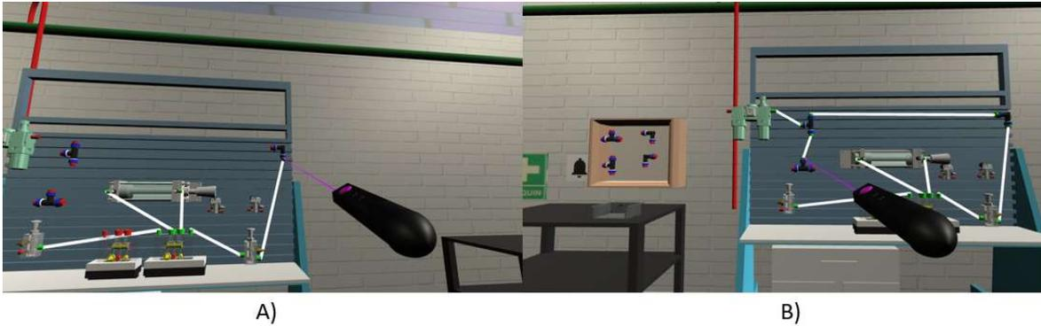
**Figura 4.21 Uniones en codo y T. A) conexión entre codo y alimentación de válvula 3/2 monoestable, B) conexiones hacia la primera unión en T**
