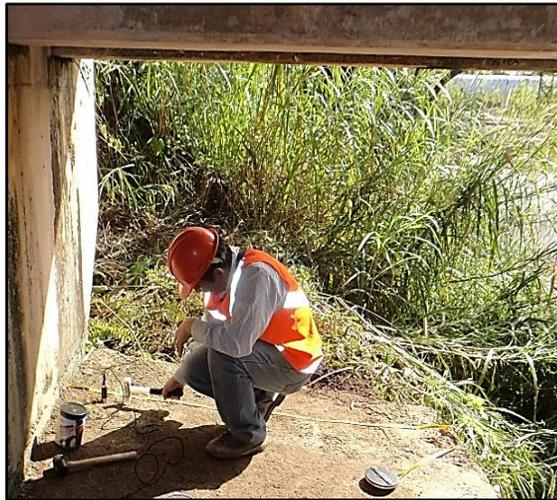
Figura 32. Realización de pruebas PIT sobre uno de los apoyos del puente. Fuente: (Sergben, Ingeniería del Subsuelo S. A. de C. V., 2013).
