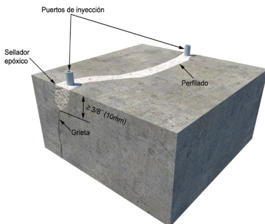
**Figura 21 Perfilado y sellado de grieta (Trout, 2006)**
