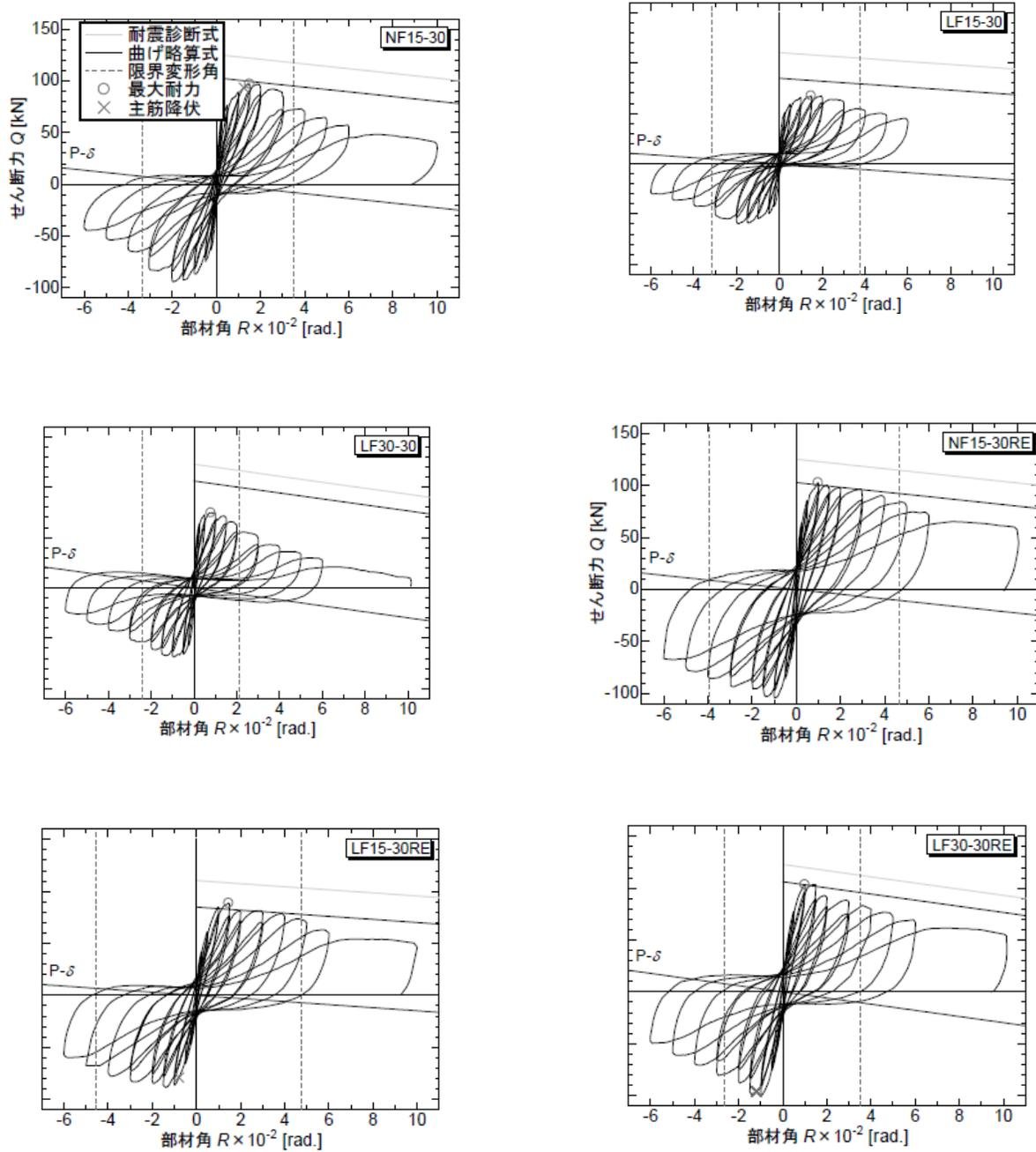
Figura 50 Curvas de histéresis fuerza cortante-distorsión de desplazamiento antes y después de la reparación (Araki e Izaki, 2012)
