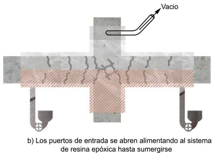
**Figura 15 Procedimiento de impregnación a vacío (French et al., 1990)**
