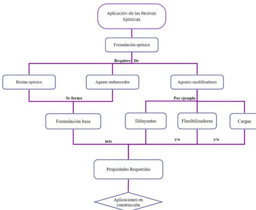
**Figura 5 Componentes principales de las resinas epoxi**
