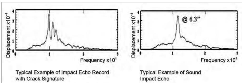
**Figura 38 Prueba de impacto eco. Grieta totalmente rellena en un solo eco o pico (Der) y parcialmente rellena con más de un eco o pico (Izq). (Goodwin et al., 2016)**
