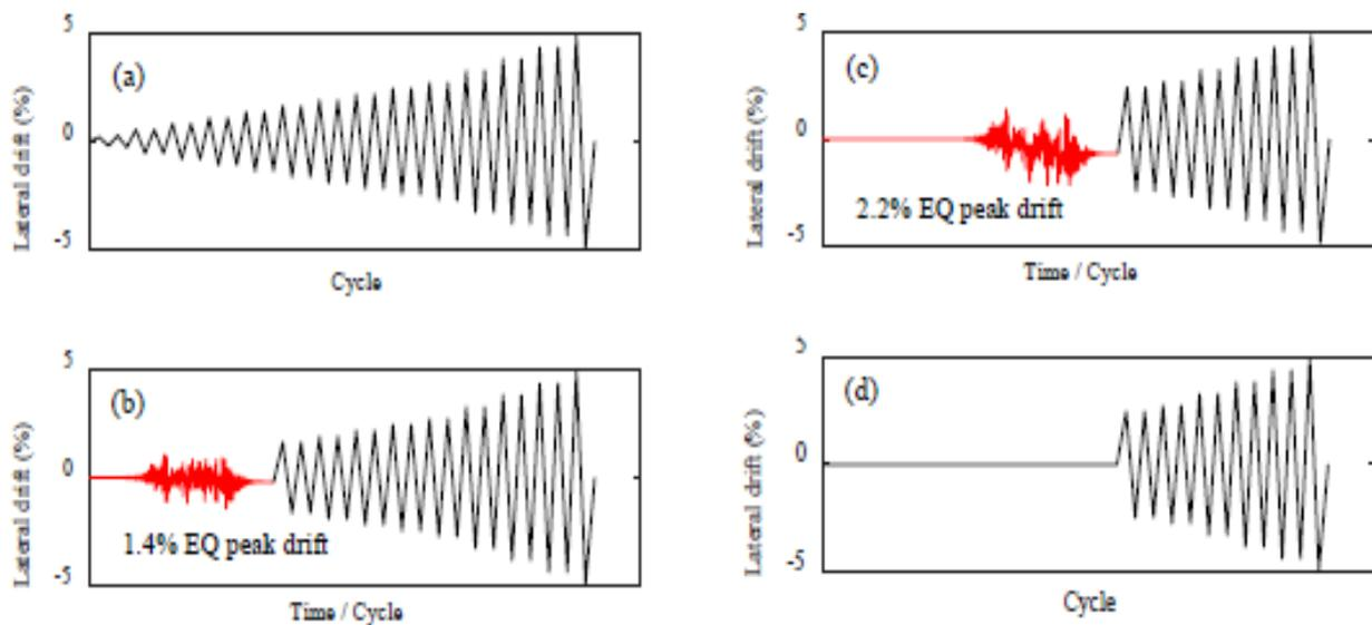
**Figura 52** Protocolos de carga aplicados a los especímenes: (a)CYC, (b) LD-1 & LD-1R (c) LD-2 & LD2-R (d)CYC-NOEQ (Marder et al., 2020)
