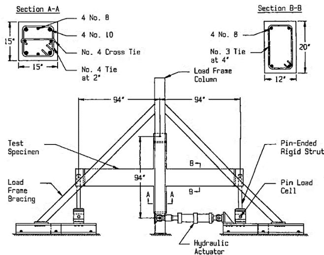
**Figura 40 Sistema de prueba y sección transversal de viga y columna (French et al., 1990)**
