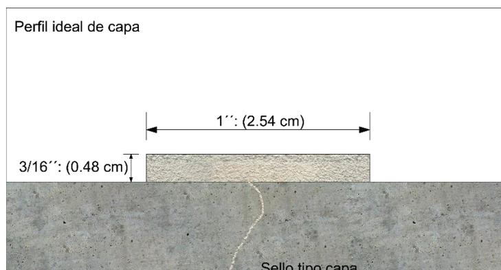
**Figura 22 Sellado de la grieta en forma de capas (Trout, 2006)**
