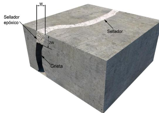
**Figura 20 Grieta sellada mediante su relleno (Trout, 2006)**
