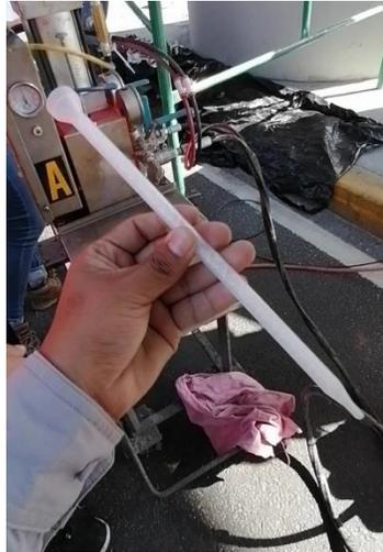
**Figura 64 Mezclador de resina y endurecedor, serpentín. (Abarca, 2021)**
