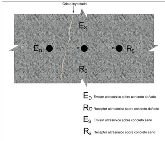
**Figura 35 Prueba de ultrasonido (Alcocer, 2019)**
