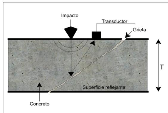
**Figura 37 Ejemplo de la prueba de impacto eco IE (Goodwin et al., 2016)**
