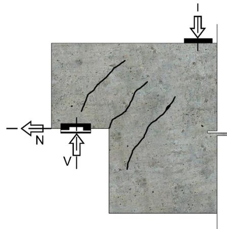
b) *Patrón de agrietamiento característico en el extremo de una viga recortada o de peralte escalonado bajo carga de servicio*
