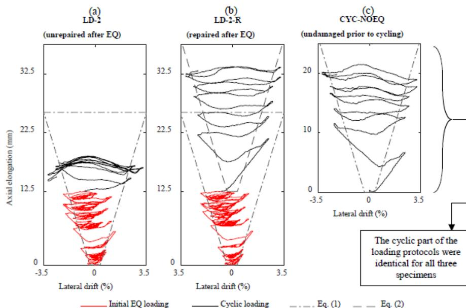
**Figura 54 Relaciones de alargamiento axial versus distorsión para las muestras LD-2, LD-2-R y CYC-NOEQ (ciclos de hasta 3.3% de distorsión)**
