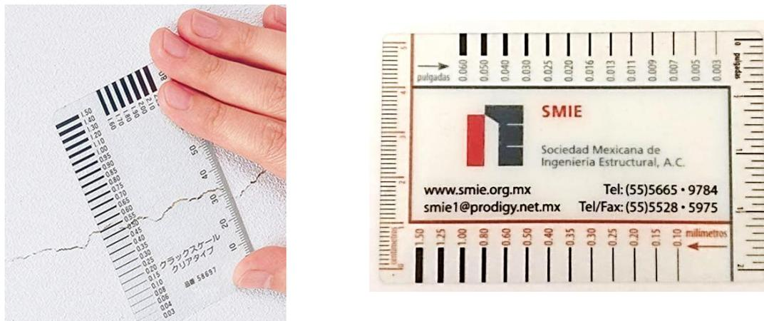
**Figura 11. Tarjeta medidora de grietas (SMIE, 2017)**
