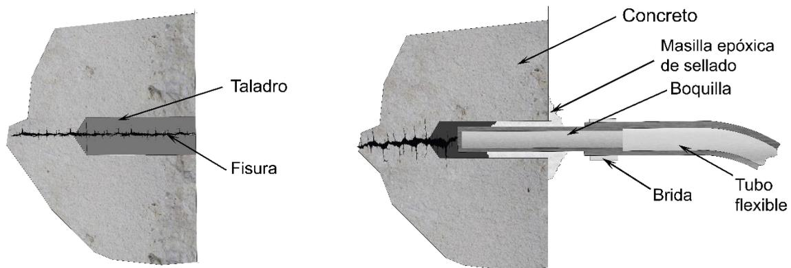
**Figura 29 Diagrama de perforación de grieta (Fernández, 1981)**
