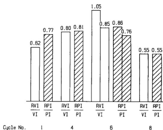
**Figura 45 Relación de disipación de energía entre los modelos reparadas y originales (French et al., 1990)**
