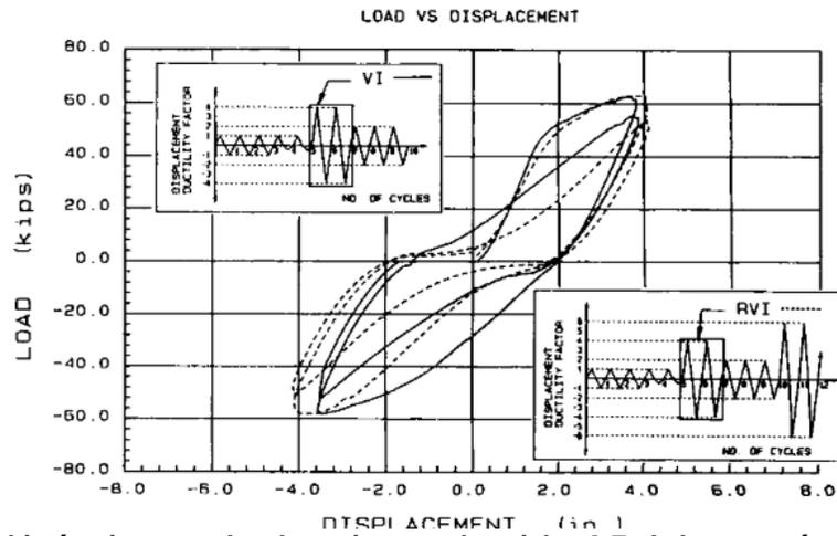
**Figura 44** Curva histéresis carga-desplazamiento en los ciclos 6-7. de los especímenes VI y RVI (French et al., 1990)
