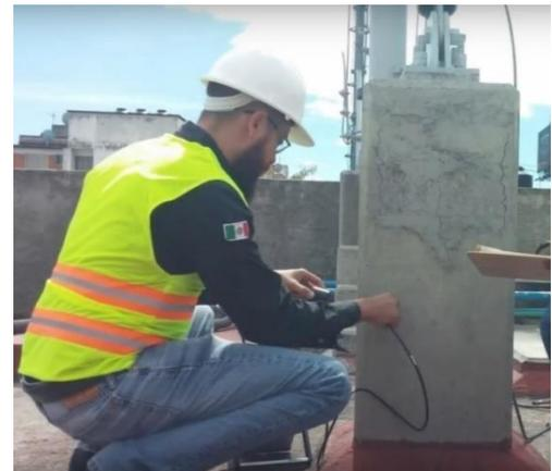
**Figura 36 Equipos para pruebas de ultrasonido (NEODEX, 2018)**
