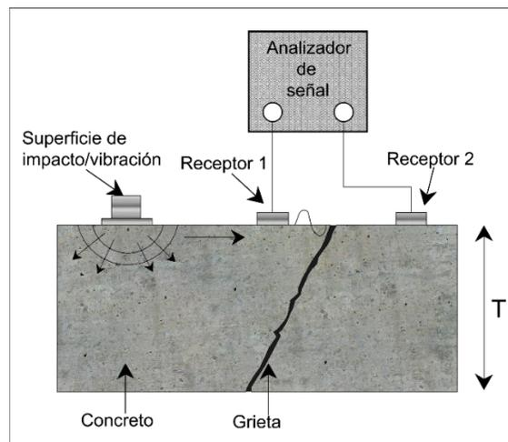
**Figura 39 Método del análisis espectral de ondas superficiales (Goodwin et al., 2016)**
