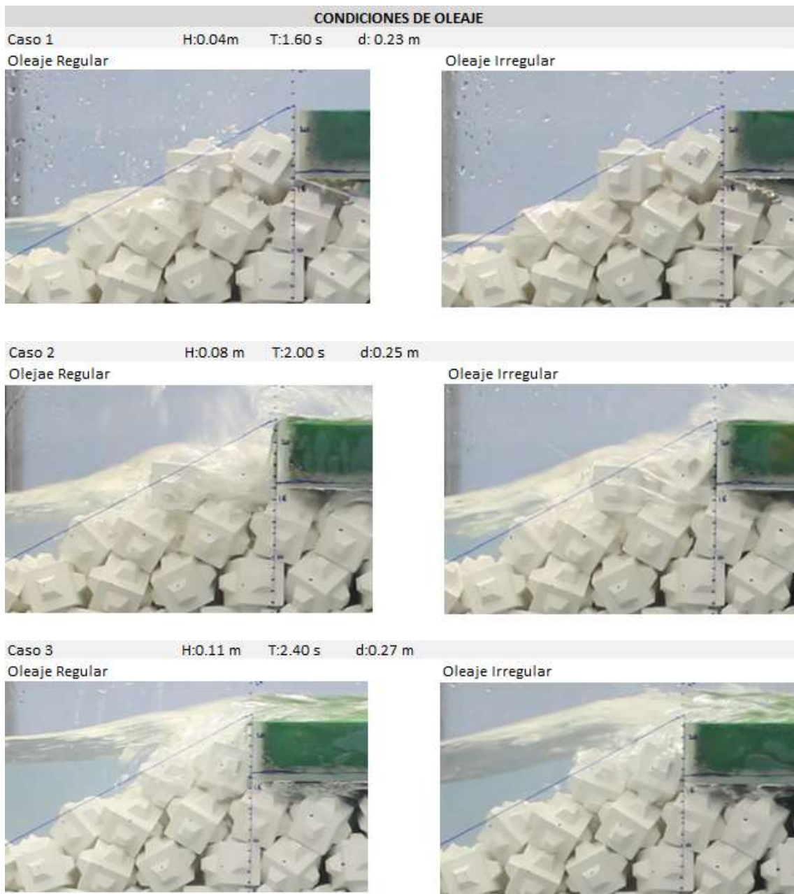
Figura 23. Oleaje Caso 2, rotura por efecto de rampa.
