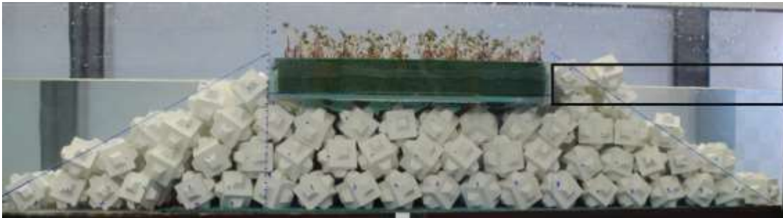
Figura 26. Toma de rebase experimental.
