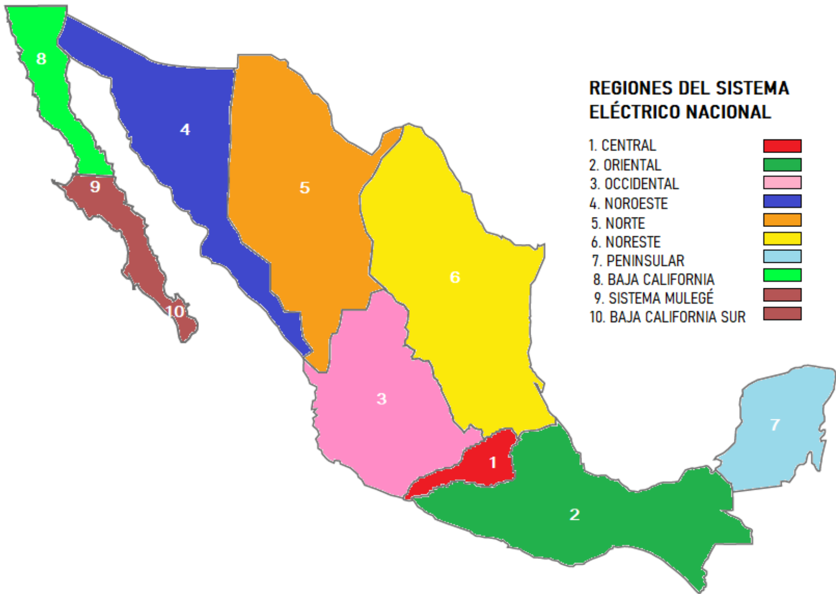
Figura 3.5: DIVISIÓN DE REGIONES DEL SISTEMA ELÉCTRICO NACIONAL
