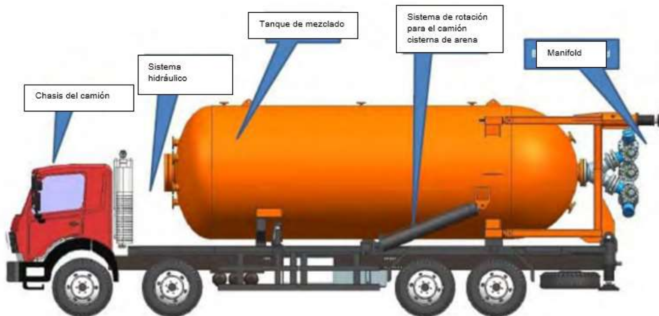
Ilustración 3-2 El diagrama de estructura del mezclador cerrado de CO 2 . [44]
