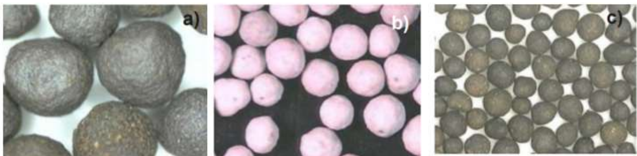
Ilustración 2-6 a) apuntalantes cerámicos de bauxita de alta densidad ( GE \sim 3,56 [g / cc]); b) apuntalantes cerámicos de baja densidad ( GE \sim 2,72 [g / cc]); (c) apuntalantes de densidad intermedia ( GE \sim 3,27 [g / cc]). [39]
