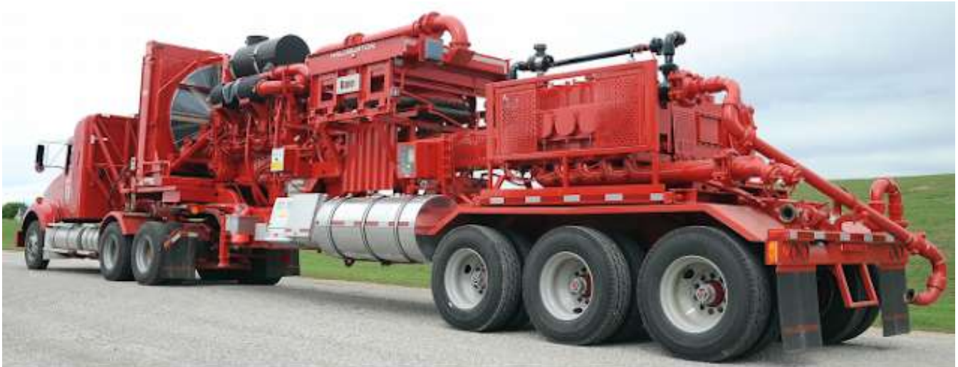
Ilustración 1-6 Unidad de bombeo a alta presión y alto gasto. [5]
