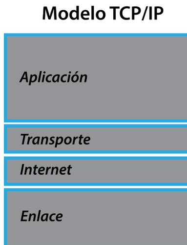
Figura 1.12: Capas del modelo TCP/IP
