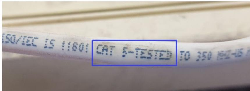
Figura 2.4: Detalle de cable UTP
