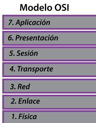
Figura 1.11: Capas del modelo OSI
