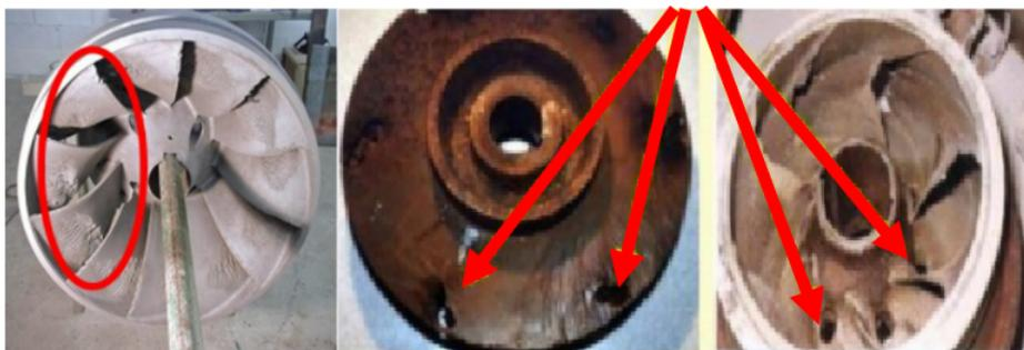
Figura 2.14: Daños causados por la cavitación [Google]
