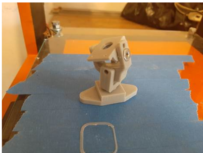
Figura 7.5: Elemento de sujeción de tres grados de libertad realizado con manufactura aditiva (Romero-Rivas, 2021)
