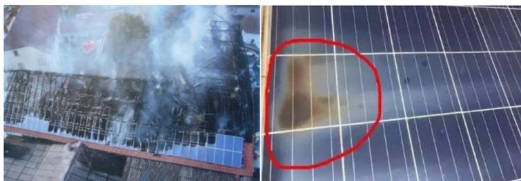
Figura 2.6: Punto Caliente en Módulo Fotovoltaico. [13]
