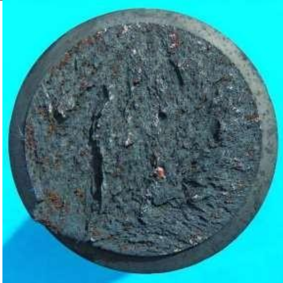
Figura 3 Falla frágil a tensión (Mora & Martínez., 2011)
