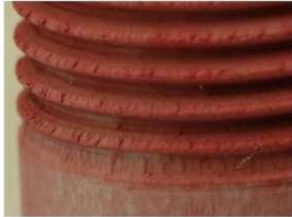
Figura 10 Presencia de micro grietas en la cuerda.
