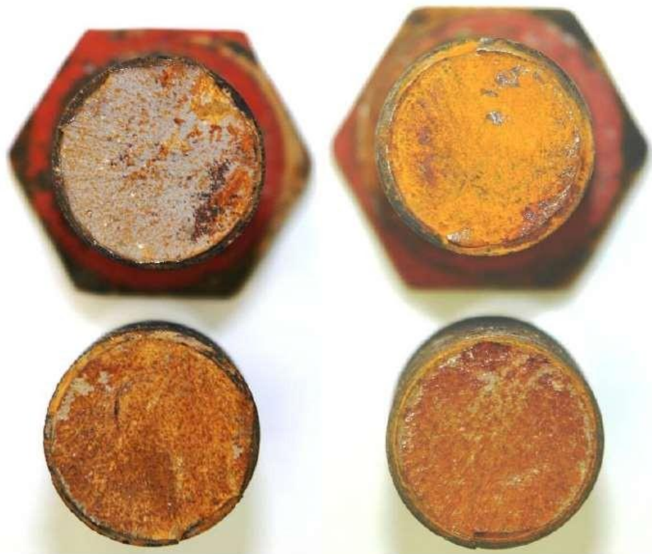
Figura 6 Zona de Fractura
