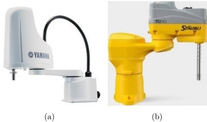
Figura 1.3.6 a) Robot Yamaha con cableado externo, b) robot Stäubli TS2-40 con cableado interno. Imágenes obtenidas de [29, 30] respectivamente.
