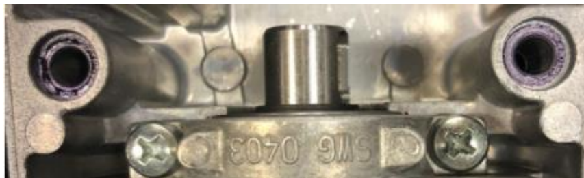
Figura 22. Ejemplificación de contacto en la base del producto por tinta al cerrar la unidad.
