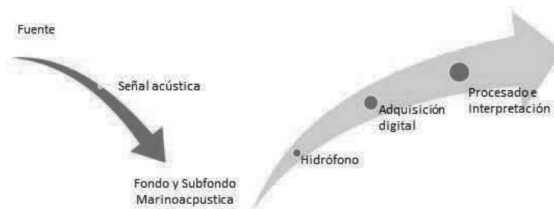
Figura 3. Diagrama del proceso básico del levantamiento con sísmica de reflexión.
