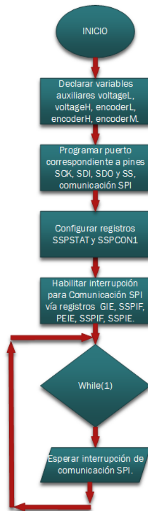
Figura 2.27: Diagrama de Flujo SPI Función Principal Esclavo
