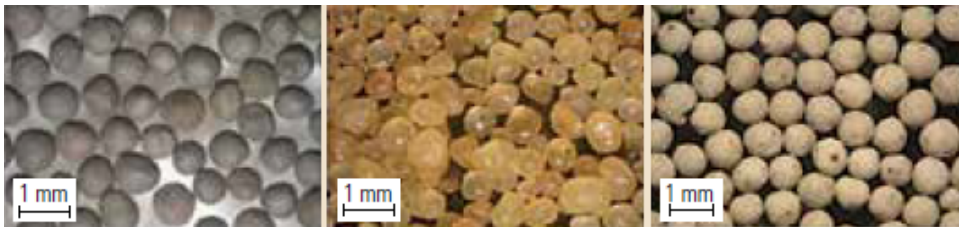
Figura 2.7: Diferentes tipos de apuntalantes: Bauxita (izquierda), Arena recubierta de resina, RCP (centro) y cerámica liviana, ISP (derecha). (4)
