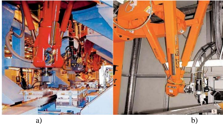
Figura 3. PKM Tricept. a) en fresado, b) en soldadura (Serje & Pacheco, 2017).
