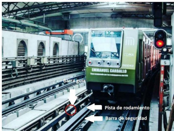
Ilustración 24. Sistema de riel electrificado, metro de la Ciudad de México. <https://www.atraccion360.com/cual-es-la-barra-con-electricidad-de-las-vias-del-metro>
