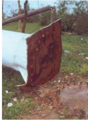
Figura 39.-Falla de la conexión placa base-tornillos. (Baeza, Vargas y Pérez, 2004)
