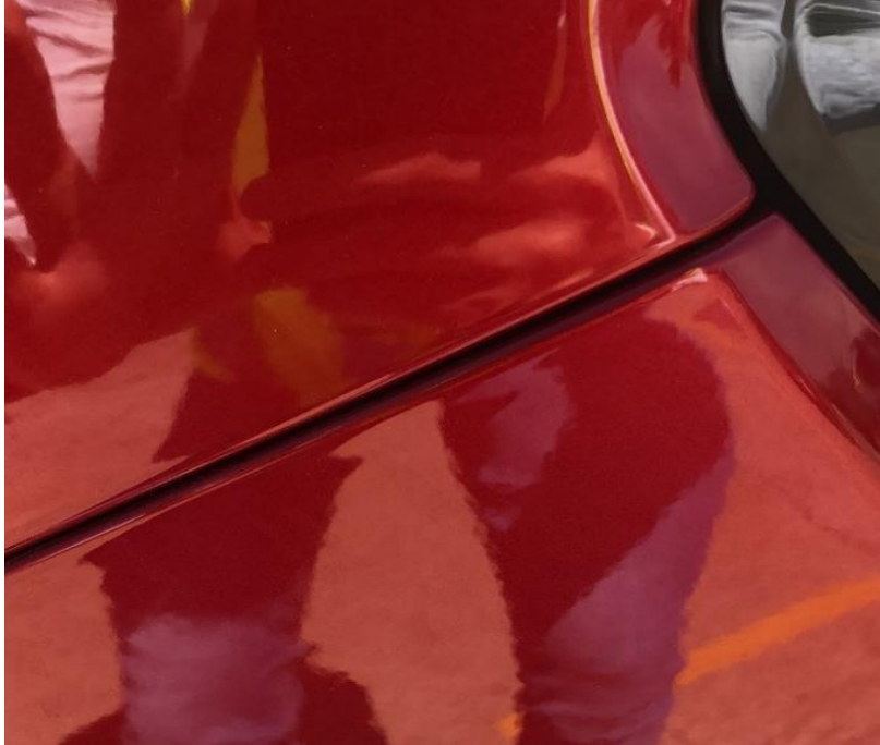
Ilustración 10. Condición de margen y enrase fuera de especificación en fascia trasera
