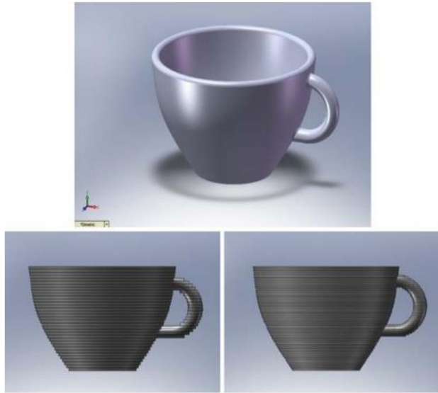
Figure 11 Dos visualizaciones de una pieza modelada en CAD, con diferentes espesores en sus capas transversales [9].
