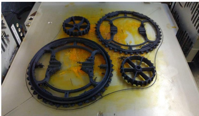
Figure 25 Impresión de la cuarta versión del mini rover en nylon con fibra de carbono.
