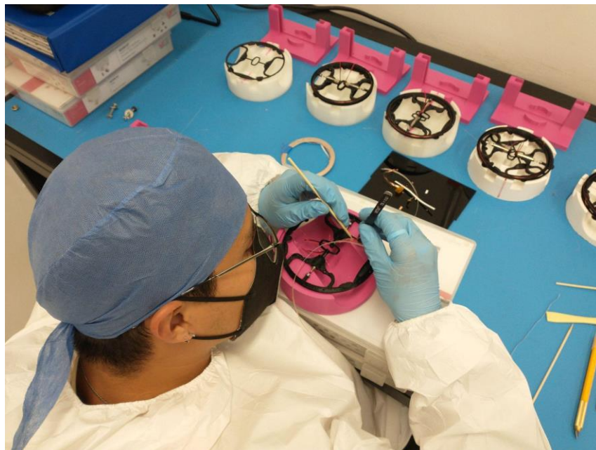
Figure 45 Ensamble de los mini rover para la misión COLMENA en sala limpia.
