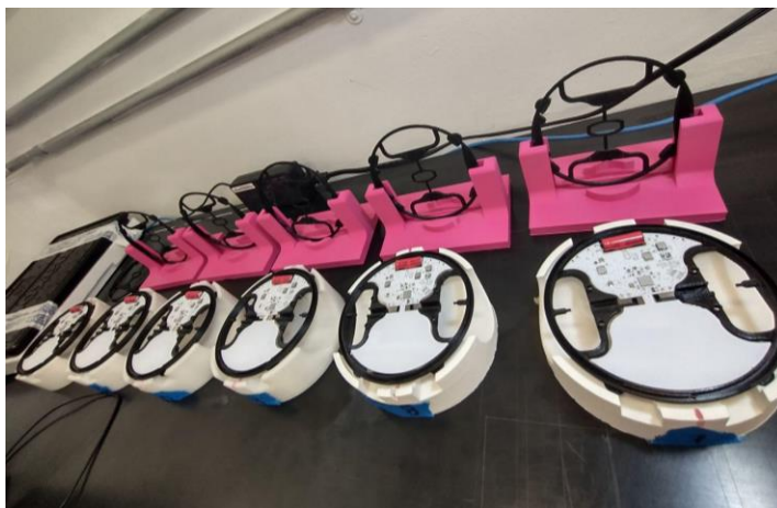
Figure 44 Preparación de los modelos de vuelo en la sala limpia de los mini rover para la misión COLMENA.
