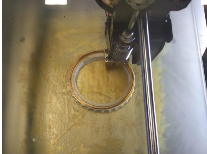
Figure 19 Injerto de la espira de cobre durante la manufactura del cuerpo del mini rover en ULTRM®.
