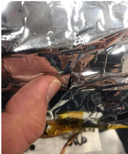
Figure 34 Cofia del TTDM desgastada después de una prueba de vibración.
