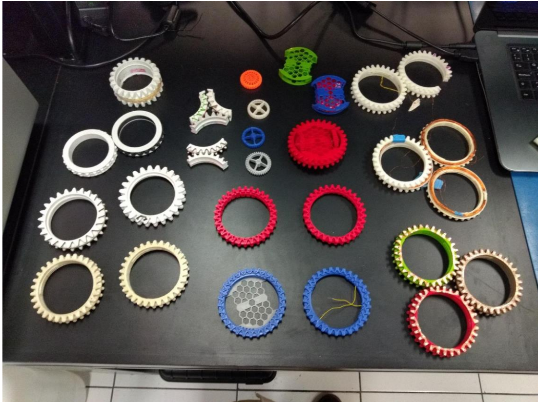
Figure 21 Impresiones de diferentes versiones del cuerpo del mini rover y otros componentes.
