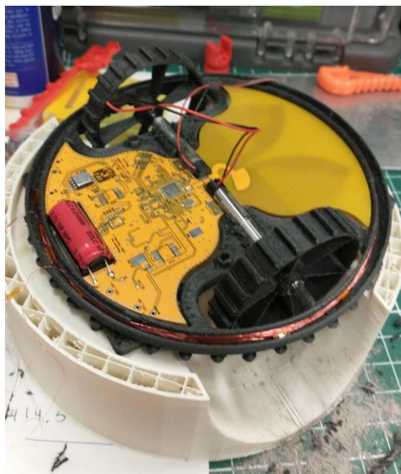
Figure 27 Quinta versión del mini rover ensamblado para pruebas de electrónica.
