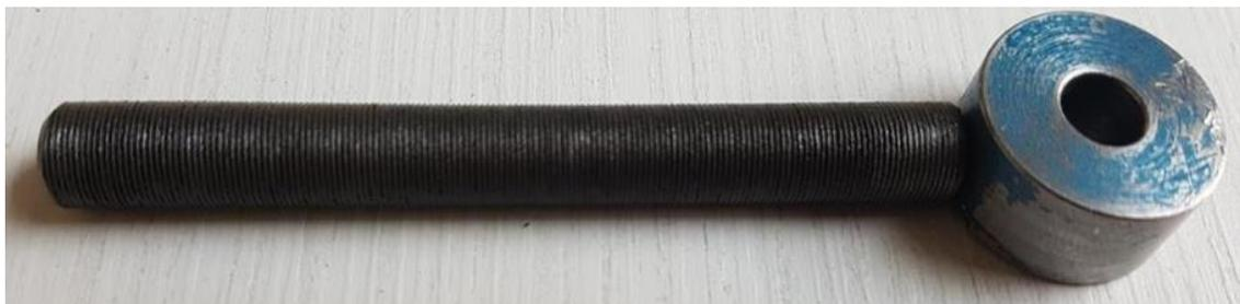
*Fig. 18: Tensor fabricado con 0.453 mm de paso o 56 hilos por pulgada.*
