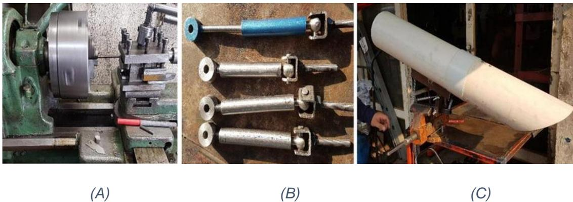
*Fig. 17: (A) Se muestra uno de los vástagos siendo procesado para añadirle las cuerdas finas. (B) Se observan las piezas terminadas. (C) Se aprecia el proceso prueba de estos tensores en el taller.*
