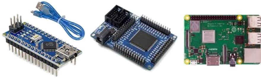
Fig. 51: Microcontrolador, FPGA, Microprocesador.
