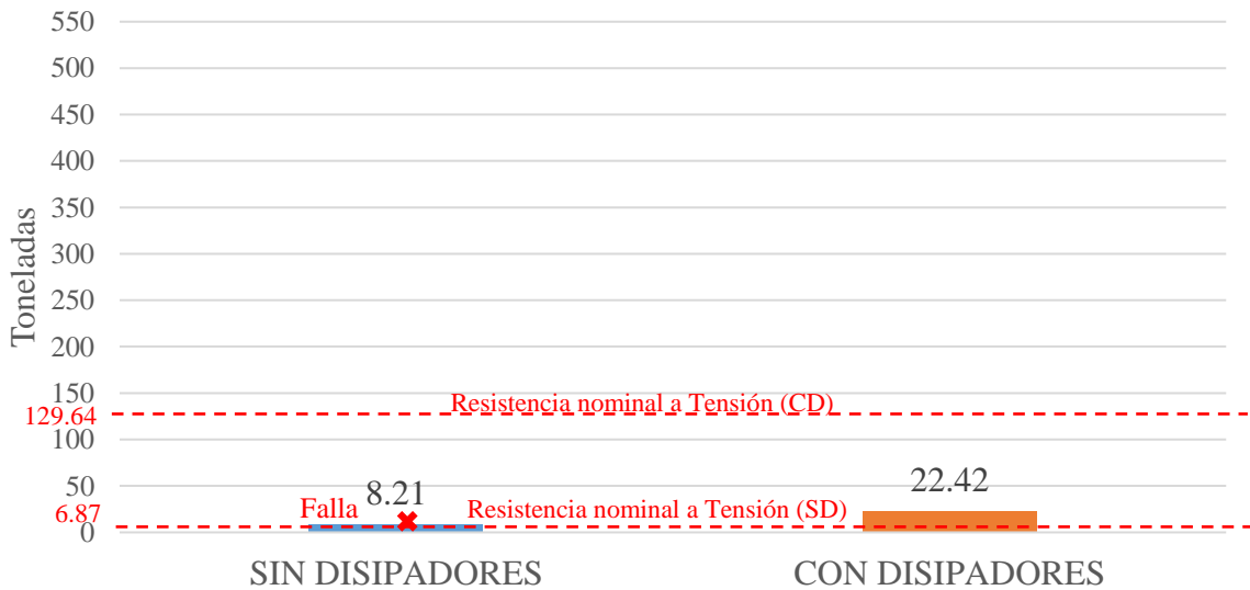
Figura 28. Tensión máxima para la intensidad del 100%
