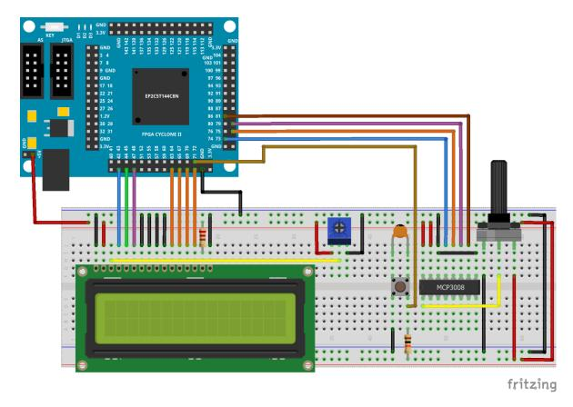
Figura 5.52 Diagrama de conexiones del circuito físico de la práctica 8 implementado en una placa de pruebas.
