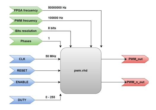
Figura 5.14 Diagrama de bloques para el generador de PWM.
