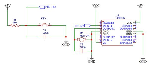
Figura 5.29 Diagrama esquemático para generador de PWM.
