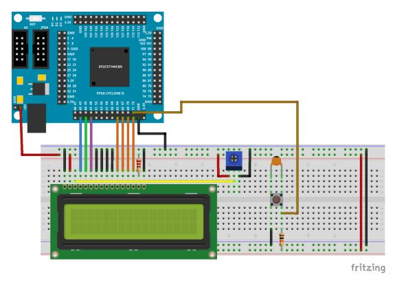
Figura 5.42 Diagrama de conexiones del circuito físico de la práctica 8 implementado en una placa de pruebas.
