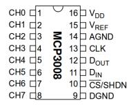
Figura 5.43 Configuración de pines del circuito MCP3008.
