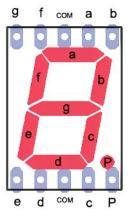
Figura 4.13 Despliegue de 7 segmentos cátodo común.
