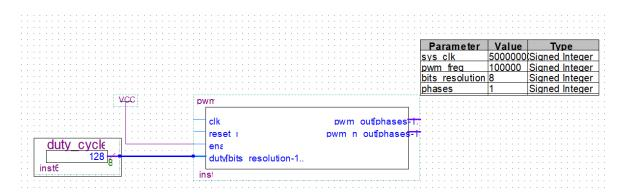
Figura 5.27 Conexión del bloque "lpm\_constant" y del bloque principal.
