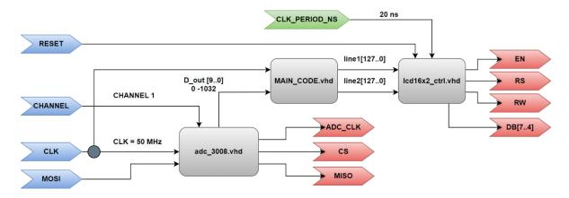
Figura 5.44 Diagrama de bloques del controlador de ADC.
