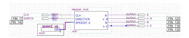
Figura 5.10 Diagrama de bloques para el controlador de motor paso a paso.
