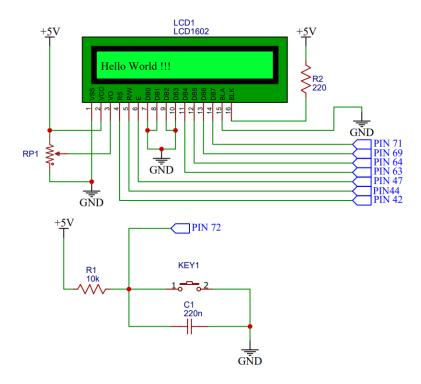
Figura 5.41 Diagrama esquemático para controlador de LCD.
