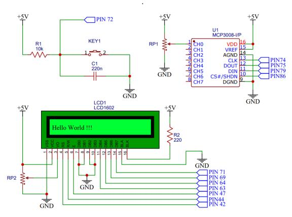
Figura 5.51 Diagrama esquemático para circuito con convertidor analógico a digital y pantalla LCD.
