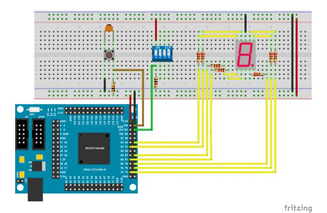
Figura 4.20 Diagrama de conexiones del circuito físico de la práctica 5 implementado en una placa de pruebas
