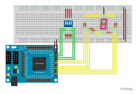
Figura 4.15 Diagrama esquemático del circuito físico de la práctica 4 implementado en una placa de pruebas.
