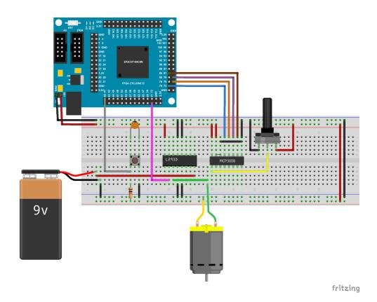
Figura 5.59 Diagrama de conexiones del circuito físico de la práctica 11 implementado en una placa de pruebas.
