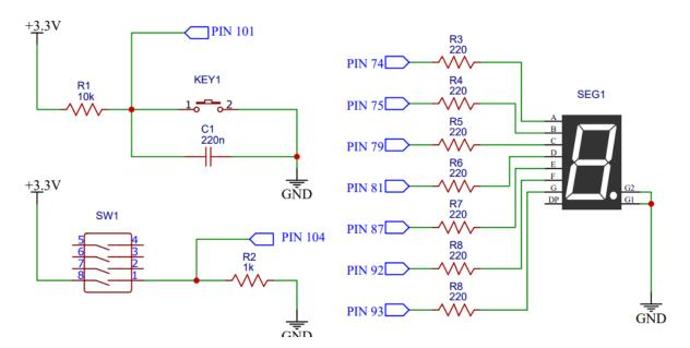
Figura 4.19 Diagrama esquemático para contador reversible de 0 a 9.
