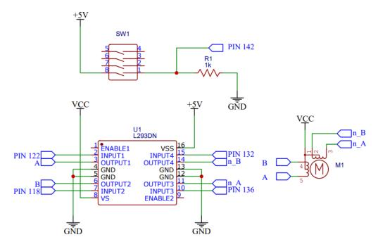
Figura 5.11 Diagrama esquemático del controlador para motor paso a paso.
