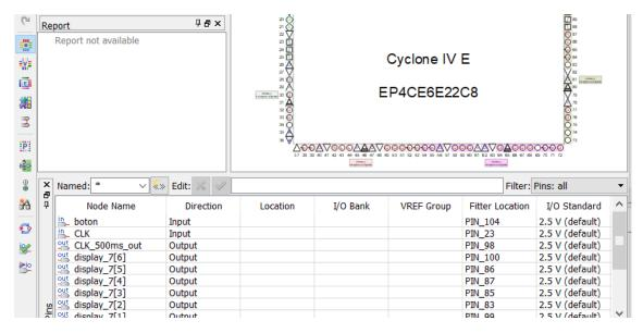
Figura 3.39 Vista previa de la configuración de pines de la Cyclone IV (arriba) y lista de las entradas y salidas del proyecto (abajo).
