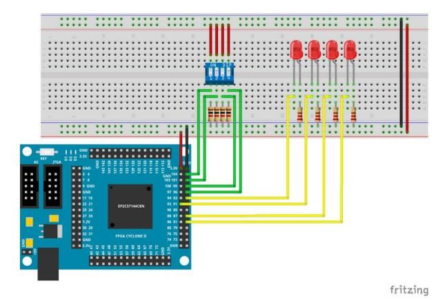
Figura 4.11 Diagrama de conexiones del circuito físico de la práctica 3 implementado en una placa de pruebas.
