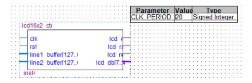
Figura B.4 Bloque del controlador para pantalla LCD 16x2.
