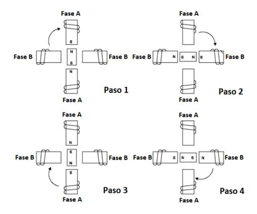
Figura 5.1 Fases para girar el rotor del motor paso a paso.
