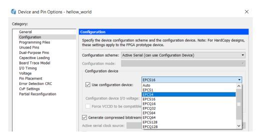
Figura 3.69 Selección del modelo de EEPROM soldado en la tarjeta del FPGA.
