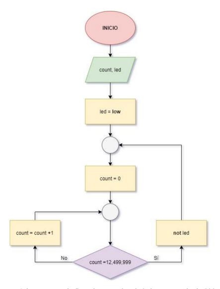
Figura 4.6 Diagrama de flujo de parpadeo de led con periodo de 500 ms.
