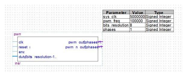
Figura B.2 Bloque generador de señal PWM.
