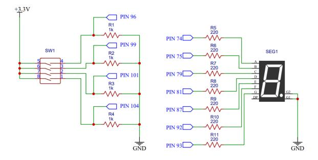
Figura 4.14 Diagrama esquemático del circuito decodificador de 4 bits a 7 segmentos.
