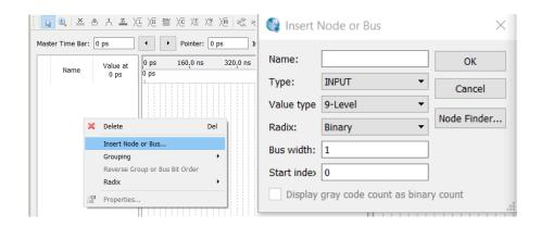
Figura 3.45 Insertar buses de entrada y salida en el simulador.
