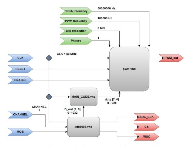
Figura 5.54 Diagrama de bloques para controlador de motor de CD.
