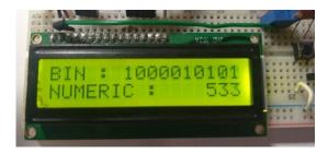
Figura 5.50 Pantalla LCD desplegando el valor del ADC en binario (arriba) y en decimal (abajo).
