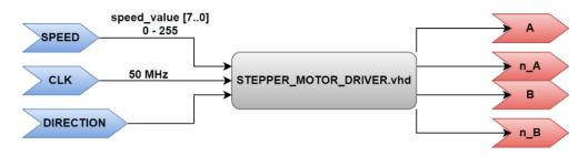
Figura 5.3 Diagrama de bloques del controlador de motor paso a paso.
