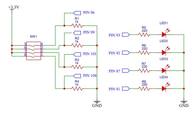
Figura 4.10 Diagrama esquemático para circuito multiplicador de 2 a 4 bits.
