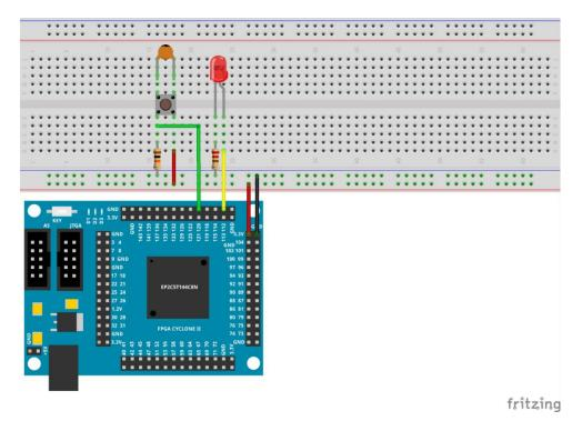
Figura 4.4 Ilustración del circuito físico de la práctica 1 implementado en una placa de pruebas.
