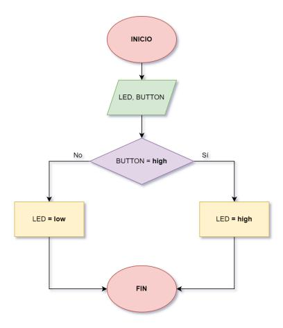
Figura 4.1 Diagrama de flujo para encender un led usando un botón pulsador.
