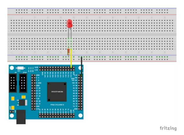
Figura 4.8 Diagrama de conexones del circuito físico de la práctica 2 implementado en una placa de pruebas.
