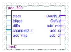
Figura B.3 Bloque de controlador para convertidor analógico a digital MCP3008.
