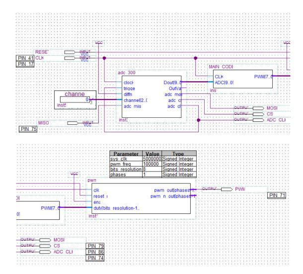
Figura 5.57 Diagrama de bloques en Quartus II para controlador de motor CD.
