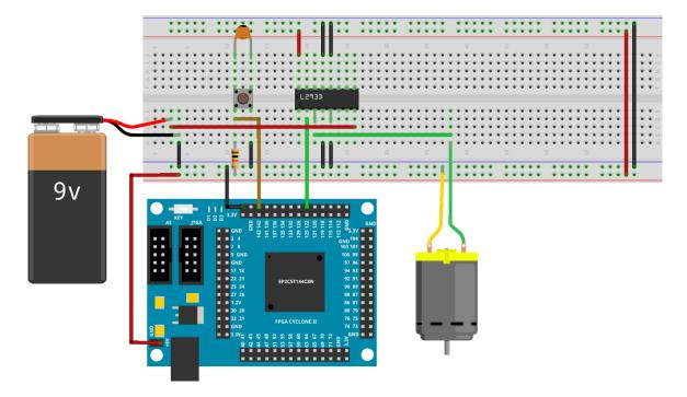
Figura 5.30 Diagrama de conexiones del circuito físico de la práctica 7 implementado en una placa de pruebas.
