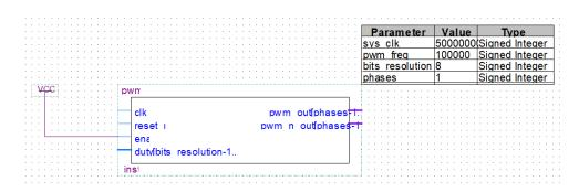
Figura 5.23 Unión entre la fuente vcc y el bloque PWM\_GENERATOR
