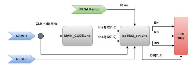
Figura 5.31 Diagrama de bloques para el manejo de un LCD implementado en FPGA.
