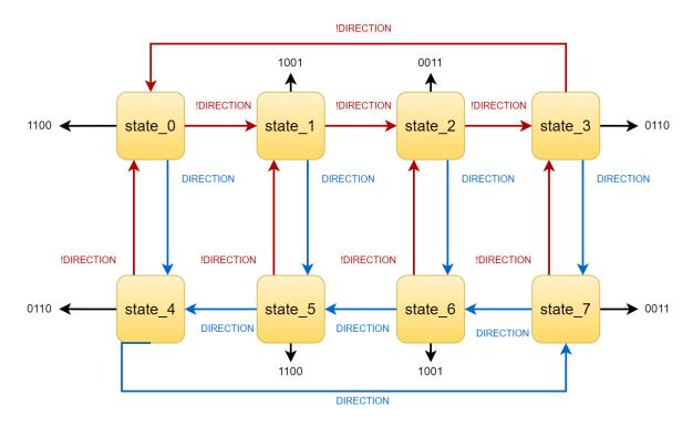
Figura 5.2 Máquina de estados para el controlador de motor paso a paso.
