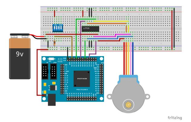
Figura 5.12 Diagrama de conexiones del circuito físico de la práctica 6 implementado en una placa de pruebas.
