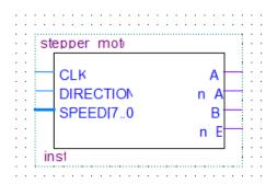
Figura B.1 Bloque del controlador de motor a pasos.
