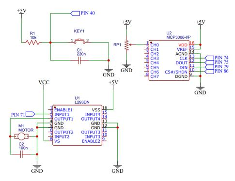
Figura 5.58 Diagrama esquemático para el circuito controlador de un motor de CD.
