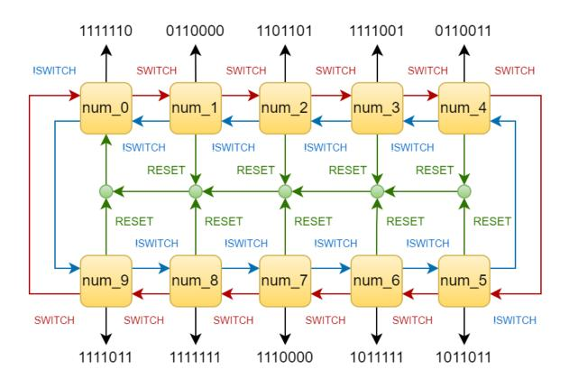
Figura 4.16 Diagrama de estados para contador reversible de 0 a 9.
