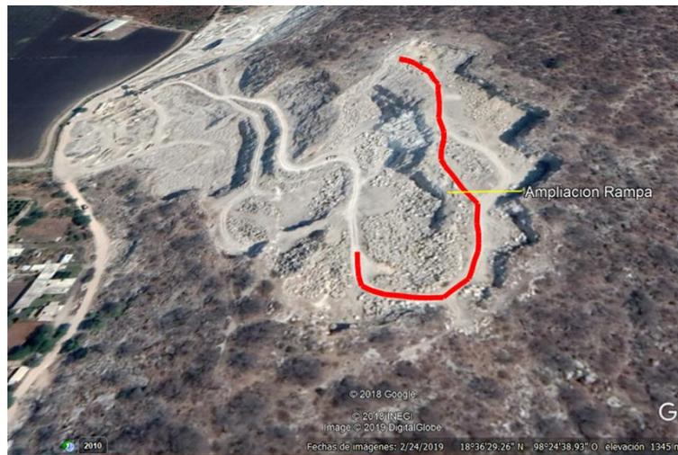
Ilustración 16 Modificación de proyecto rampa.
