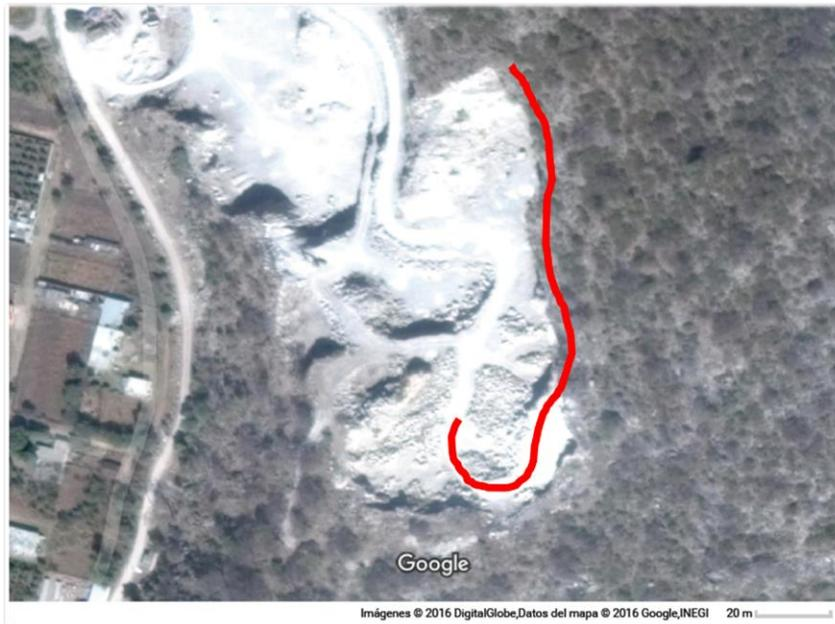
Ilustración 4 Proyecto de rampa para apertura de nuevo banco.
