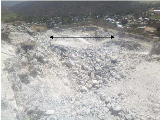
Ilustración 10 Desplazamiento de material de voladura.
