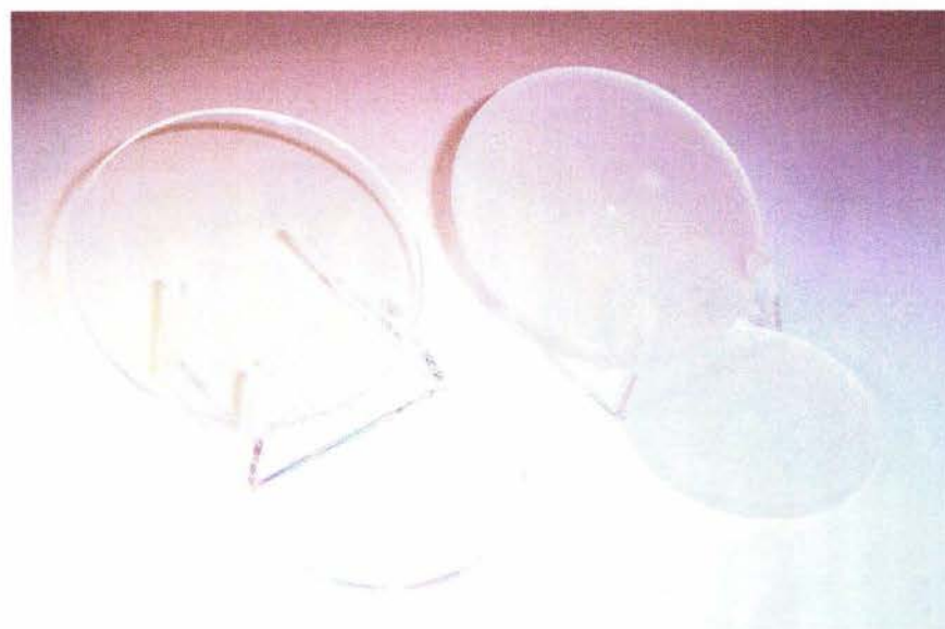
Fotografía 5.F.39. Discos de acrílico transparente de 6 mm de espesor y de 10 y 14 cm de diámetro con perforación central de 3 mm de diámetro. A la izquierda se muestran los transparentes y a la derecha, los esmerilados.
