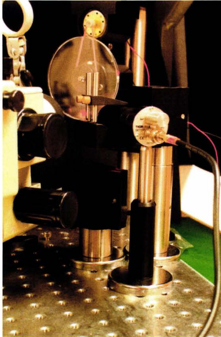
Fotografía 5.F.67. Posición final del conjunto receptor óptico para una configuración de retroesparcimiento. Se muestra la base del fotodetector y el sujetador V que sostiene los tubos portalentes.
