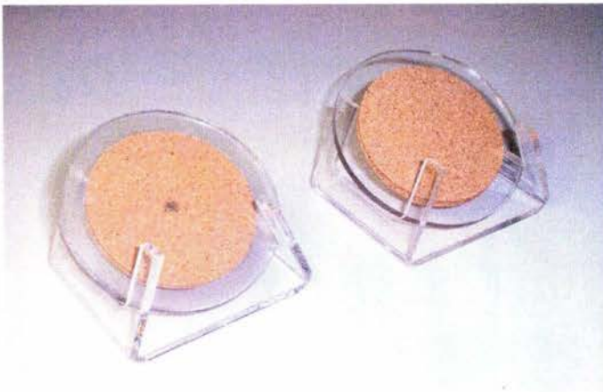
Fotografía 5.F.63. Discos con círculos de corcho. A la derecha, un disco normal; a la izquierda, un disco con un anillo de plástico semitransparente encapsulado en su sector libre de corcho con ayuda de mica autoadherible. En otros de estos discos se emparedaron anillos circulares de otros materiales y polvo de talco en diferentes concentraciones.
