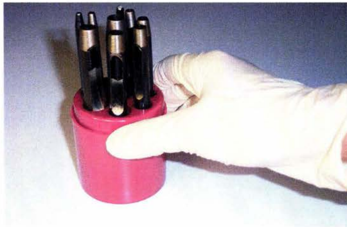
Fotografía 5.F.50. Juego de sacabocados y guantes de látex utilizados para la fabricación de diafragmas y pantallas.
